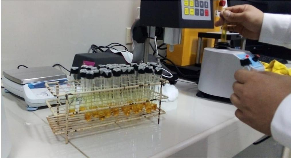
Figura 3. Determinación de azúcares reductores
