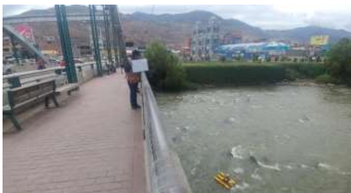
FIGURA N° 9 Aforo con ADCP puente San Sebastián [Fuente: propia]
