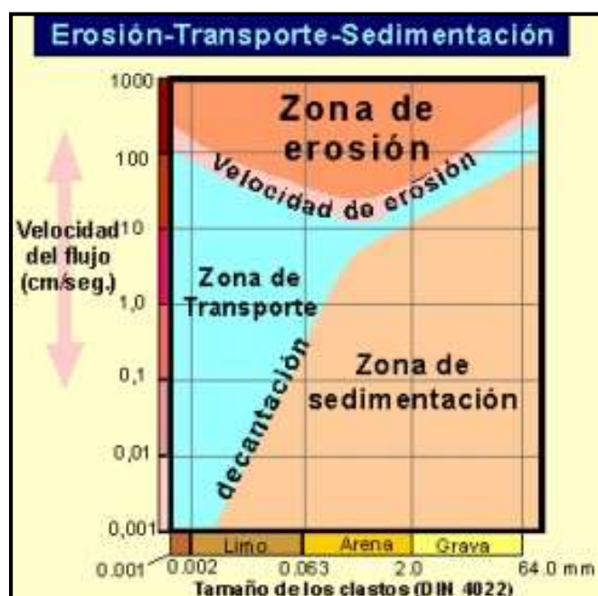
FIGURA N° 1 Representación esquemática del transporte de sedimentos de acuerdo a la velocidad del flujo [Fuente: Quincho, 2012]
