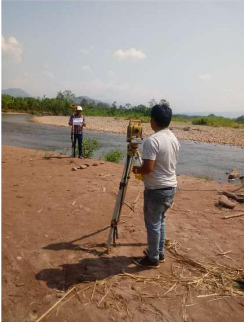
**Foto N°08:** Tesista y personal junto al prisma, dando inicio al seccionamiento del cauce
