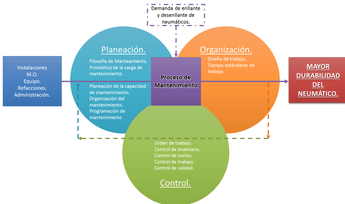
Gráfico 31 Sistema de gestión de mantenimiento para la durabilidad de los neumáticos O.T.R. para camiones de acarreo
