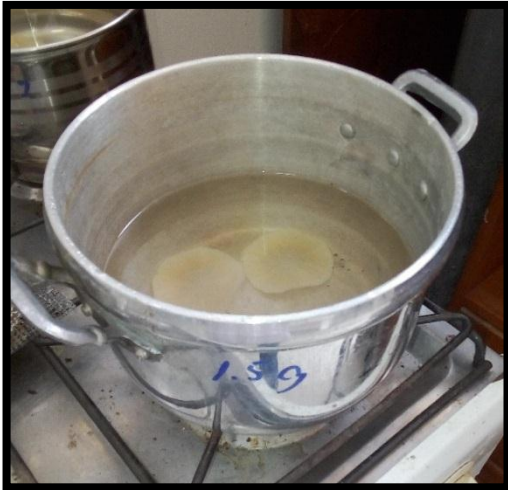
Figura 7. Tratamiento hidrotérmico con 1.5gr de concentración de ac. ascórbico
