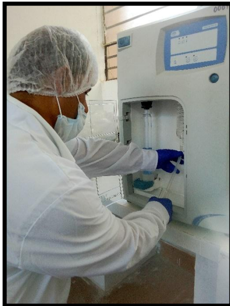
Figura 22. Determinación de proteínas - Destilación
