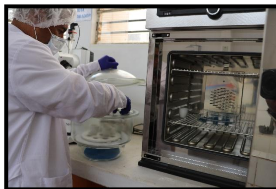
Figura 20. Crisoles de porcelana (ceniza) y vidrio (fibra) a estufa
