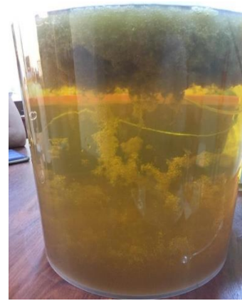
Figura 20. Seguidamente se filtra y se diluye con alcohol, y se observa la precipitación del hidrocoloide
