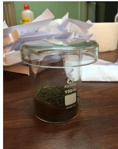
Figura 26. Finalmente se obtuvo el hidrocoloide de cushuro con un rendimiento de 0.20% por kilogramo de cushuro fresco
