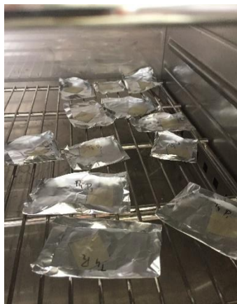
Figura 43. Determinación de humedad y solubilidad en agua de la película
