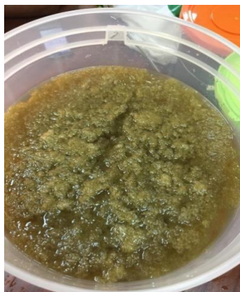
Figura 21. Dejamos reposar hasta que precipite todo el hidrocoloide
