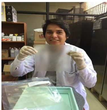
Figura 37. Pasado el tiempo mencionado, se retiró las bandejas de la estufa para poder desplegar las películas
