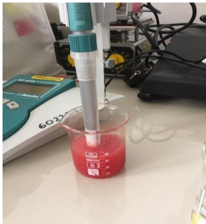
Figura 47. Determinación de pH de las muestras en estudio en conservación (tomates)
