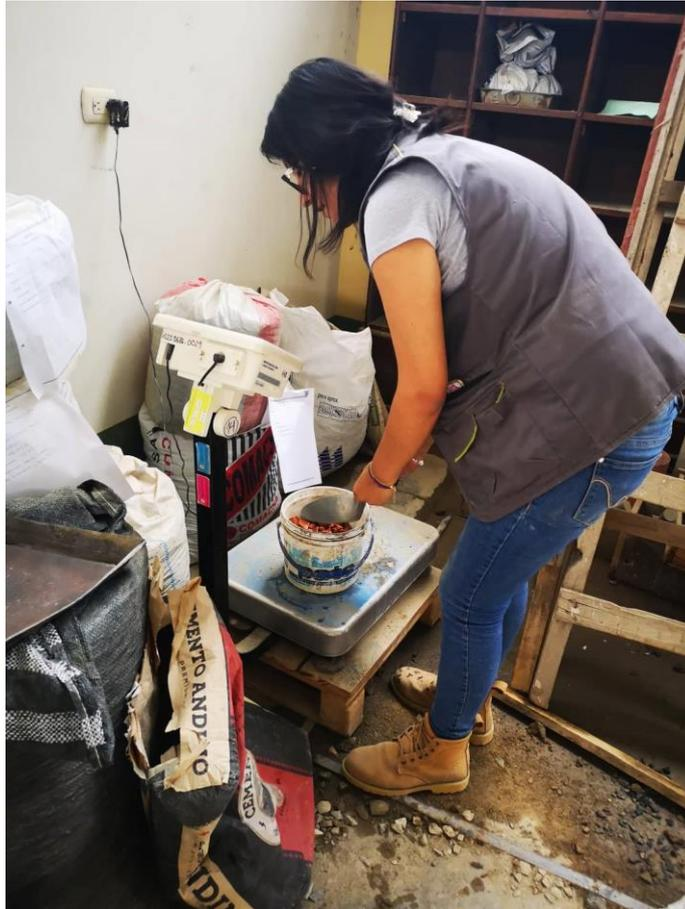
*Imagen N° 3: Fotografía de pesaje de agregados para la mezcla.*
