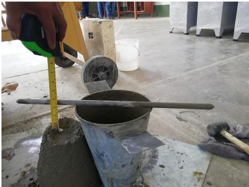
*Imagen N° 6: Fotografía de la prueba de abrams para el concreto fresco.*
