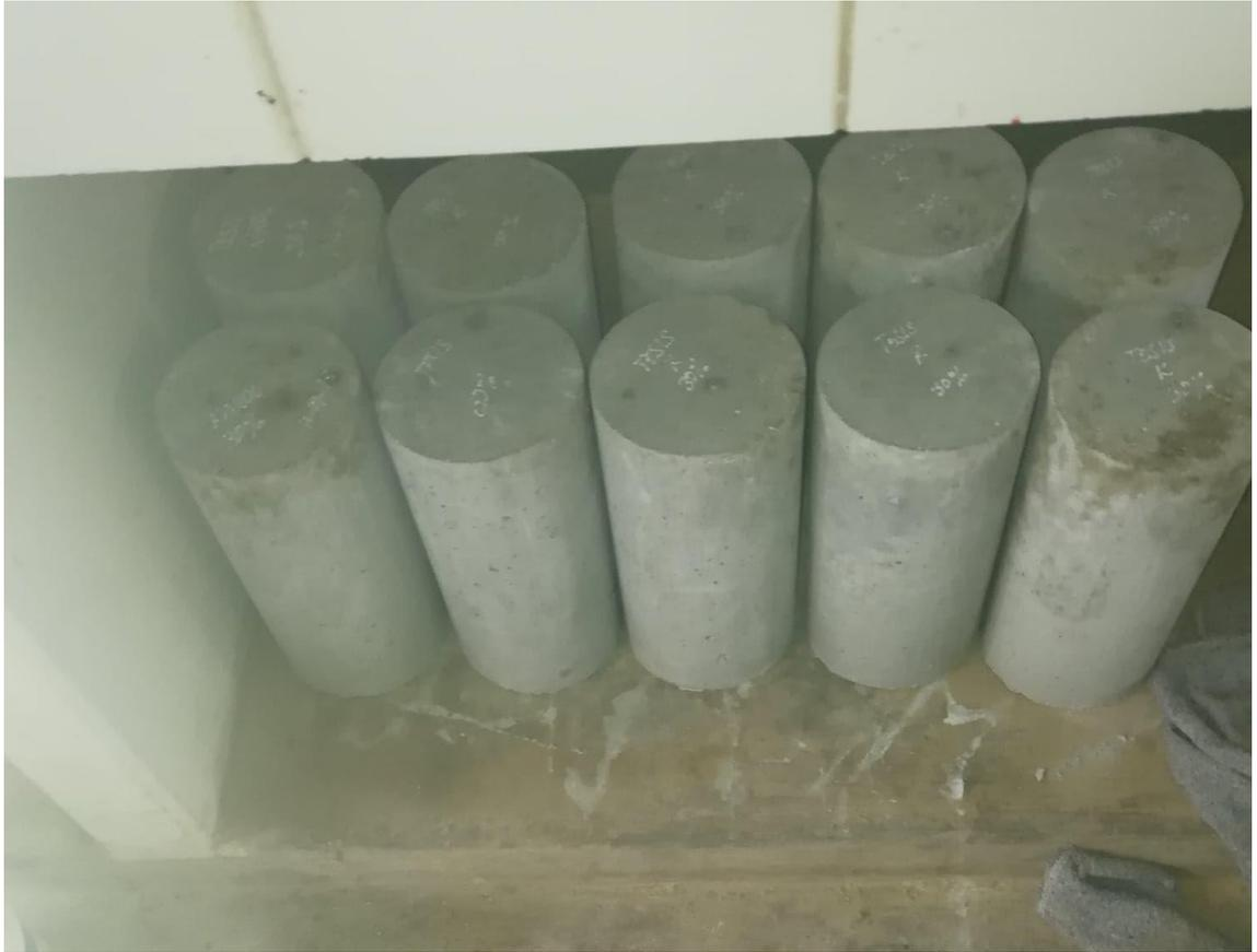
*Imagen N° 10: Fotografía de las probetas ya realizadas, con adición de ladrillo.*
