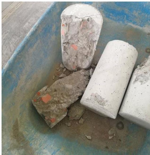
*Imagen N° 09: Fotografía de la distribución del ladrillo en la probeta ensayada*
