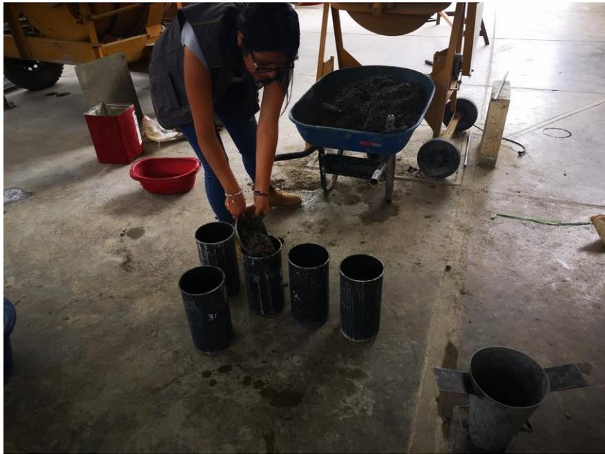
*Imagen N° 7: Fotografía de echado de concreto a las probetas.*
