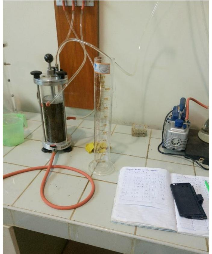
Figura N°94 Medición del volumen y tiempo
