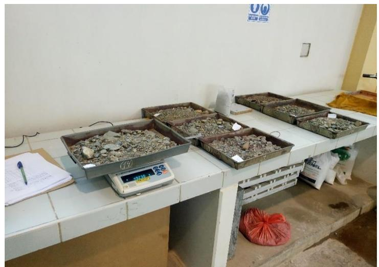
Figura N°82 Pesado de la muestra sacada del horno
