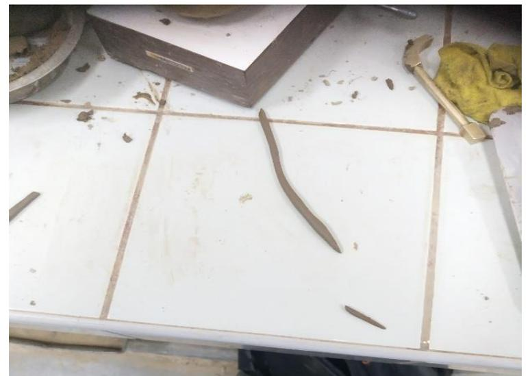
Figura N°86 Determinación del límite plástico
