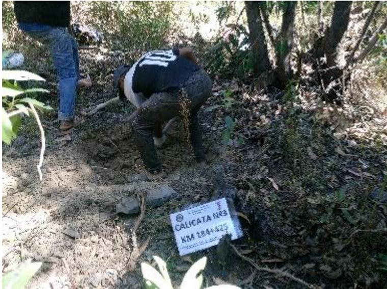
Figura N°65 Excavación de la Calicata N°3 Km 184+425
