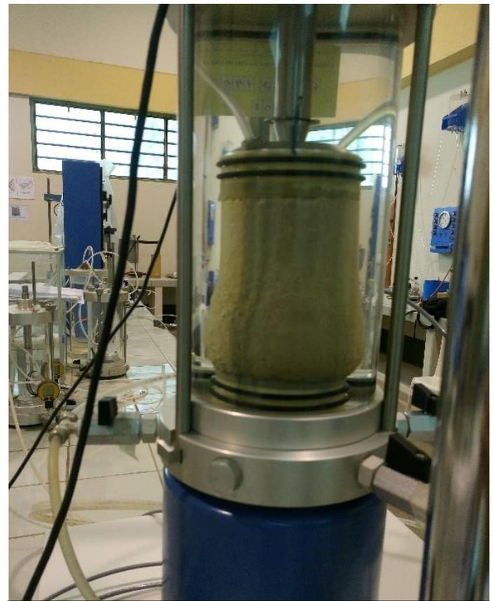
Figura N°108 Verificación de la falla plástica
