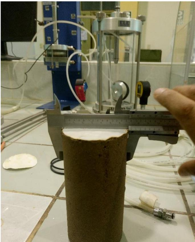
Figura N°99 Medición del diámetro
