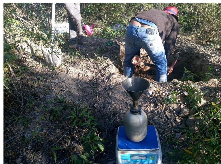
Figura N°75 Control de los Pesos Mediante una Balanza
