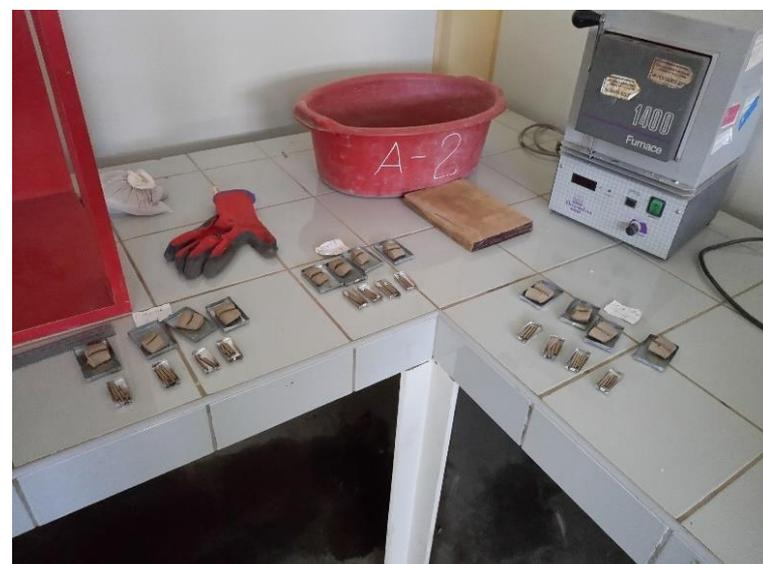
Figura N°87 Colocación de las muestras al horno
