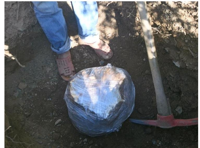
Figura N°76 Extracción de Las Muestras Inalteradas
