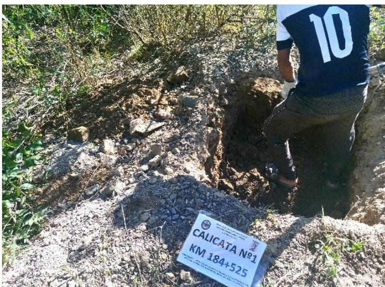
Figura N°69 Excavación de la Calicata N°1 Km 184+525
