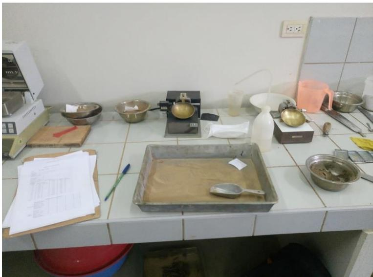
Figura N°85 Determinación del límite líquido
