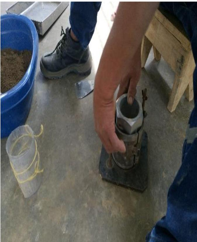
Figura N°95 Preparación del molde
