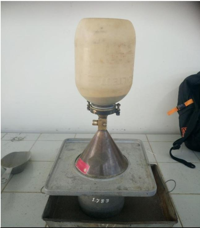
Figura N° 61 Vaciado de La Arena en Volumen
