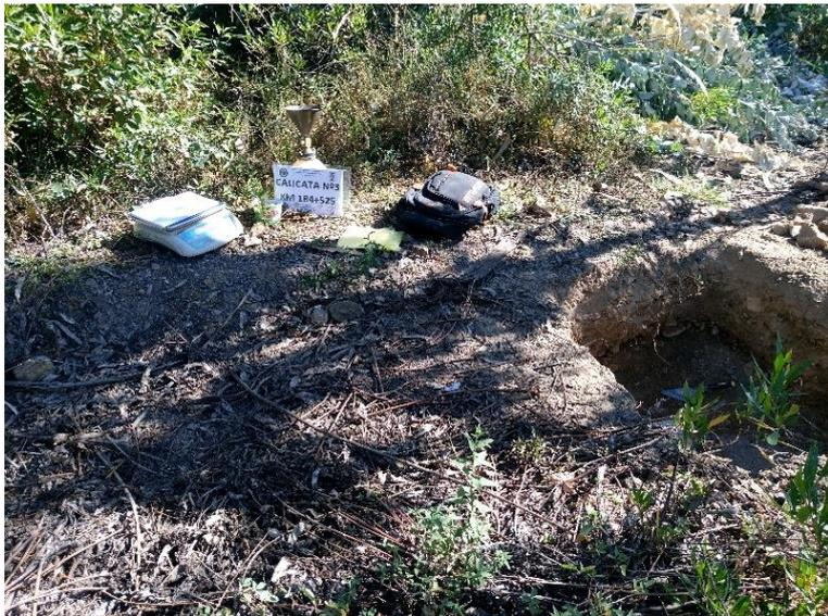
Figura N°71 Excavación de la Calicata N°3 Km 184+525
