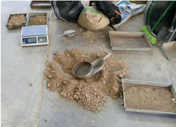
Figura N°79 Separación de las Muestras
