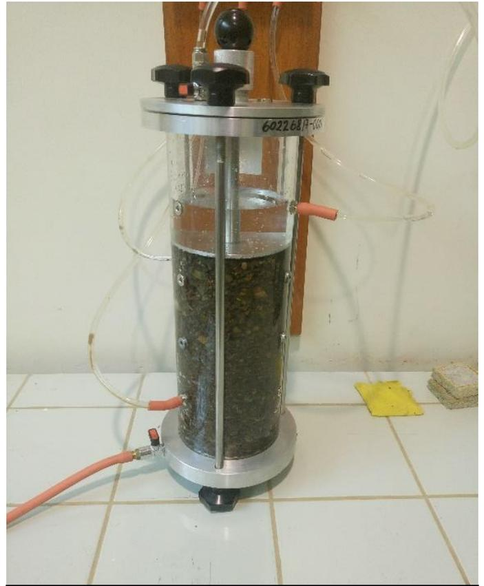
Figura N°90 Saturación de la muestra
