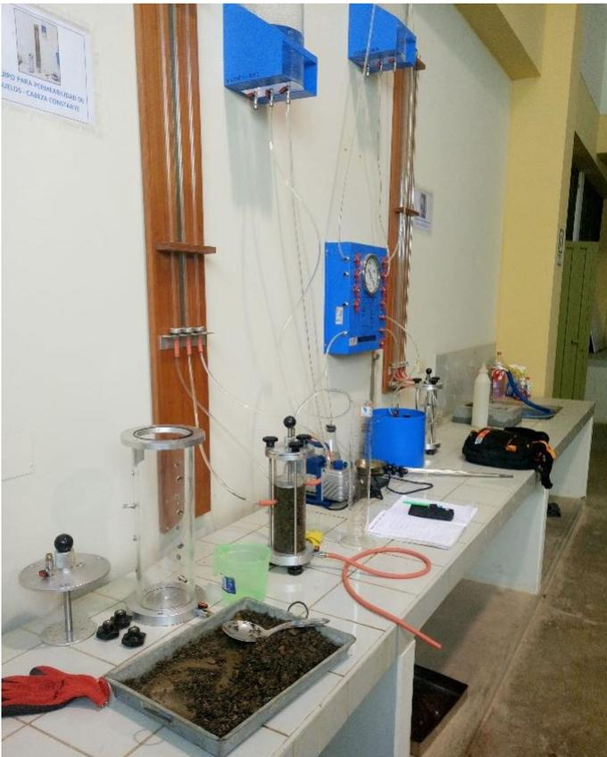
Figura N°91 Verificación de los piezómetros
