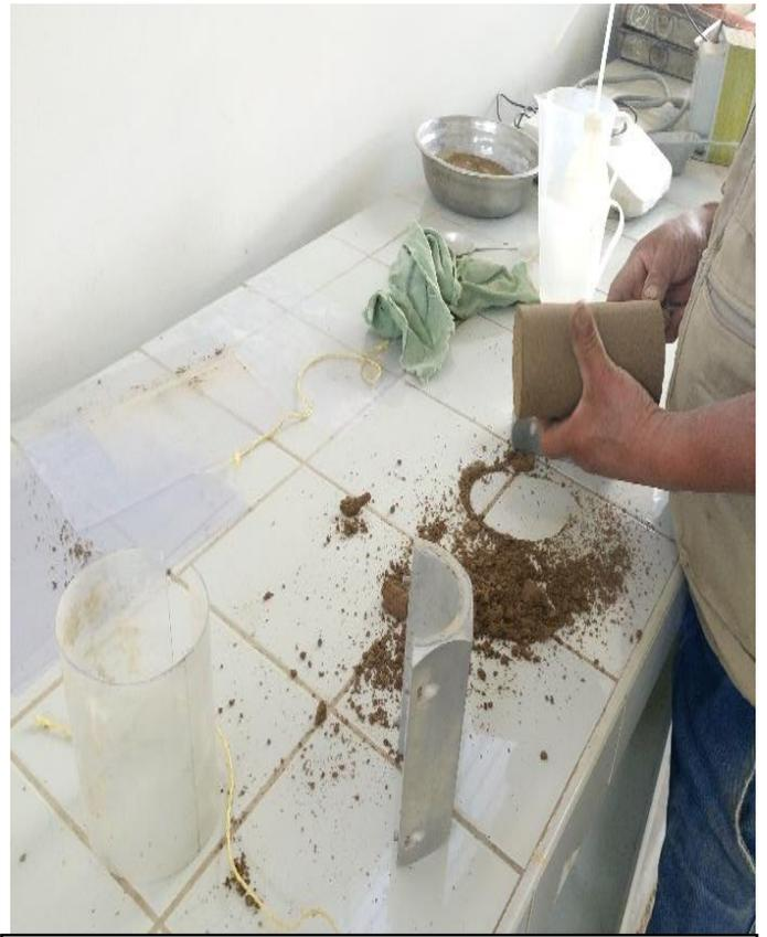
Figura N°98 Perfilado de la muestra
