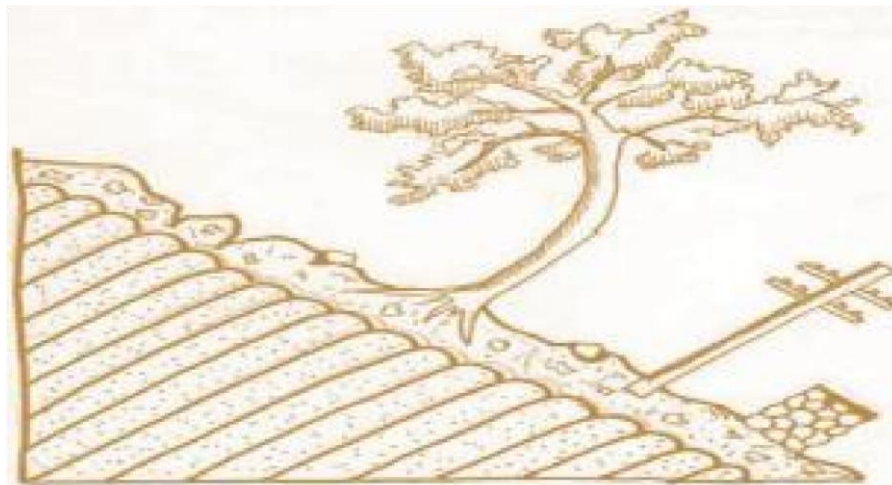
Figura N° 3: reptación de suelos
