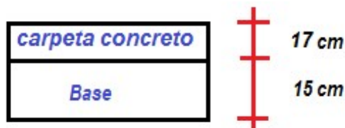
Figura N° 22: Estructura del pavimento rígido – método MTC
