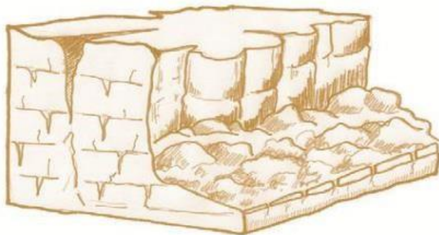
Figura N° 1: derrumbes y caídas de bloques
