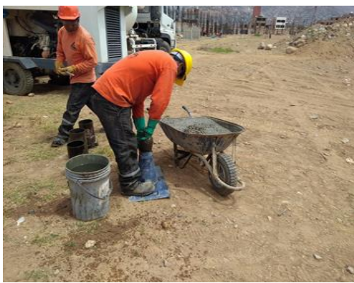
Foto N° 16: Se saca las muestras en la probeta para realizar la prueba de rotura en el laboratorio y ver la Resistencia en los 7, 14 y 28 días, del Sector Norte.
