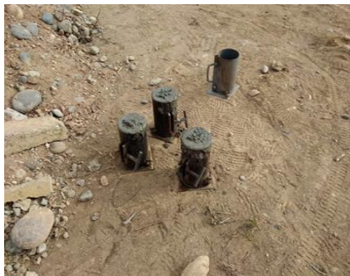
Foto N° 13: Se saca las muestras en la probeta para realizar la prueba de rotura en el laboratorio y ver la Resistencia en los 7, 14 y 28 días, del Sector Sur.
