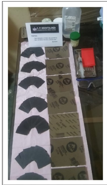
Figura N° 56, 57, 58: En el laboratorio High Technology Laboratory S.A.C, fotografías de las autoras. Primero se desgasto la cara vestibular de los dientes con una pulidora a motor haciendo uso de lijas de agua hasta exponer dentina superficial empezando por la gruesa a la más fina de las lijas n° (80,120,400,600,1000 y 1200)
