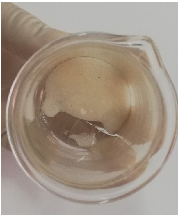
Figura 11. Colocación de Sulfato de Sodio Anhidrido . Fuente Autoras
