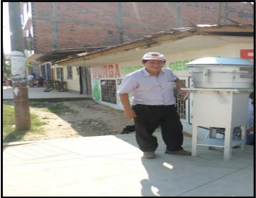
Foto 3. Instalando para la evaluación de calidad de aire con el equipo de alto volumen (Hivol).
