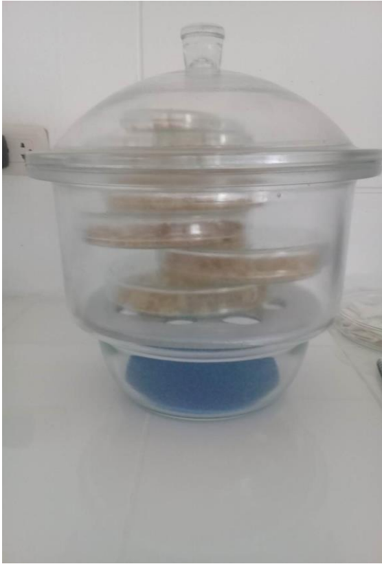
Figura N° 20,4. Enfriado y pesado de las muestra de papas fritas.
