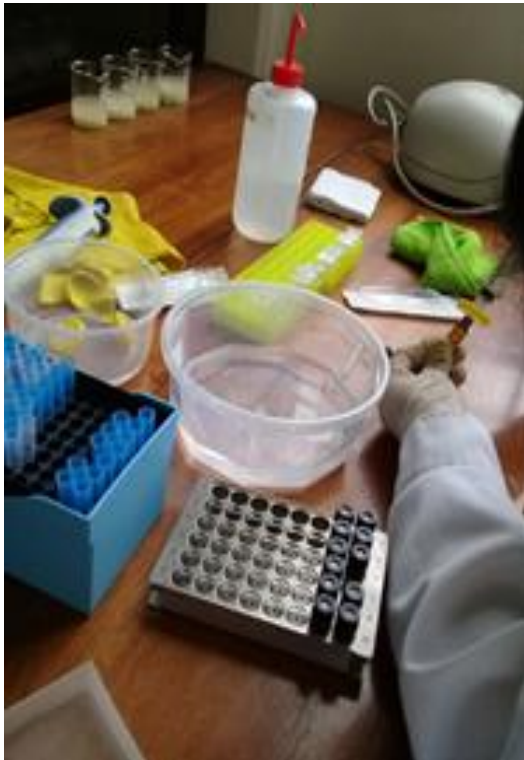
Figura 25,6. Filtrado y llenado de las muestras en los viales.
