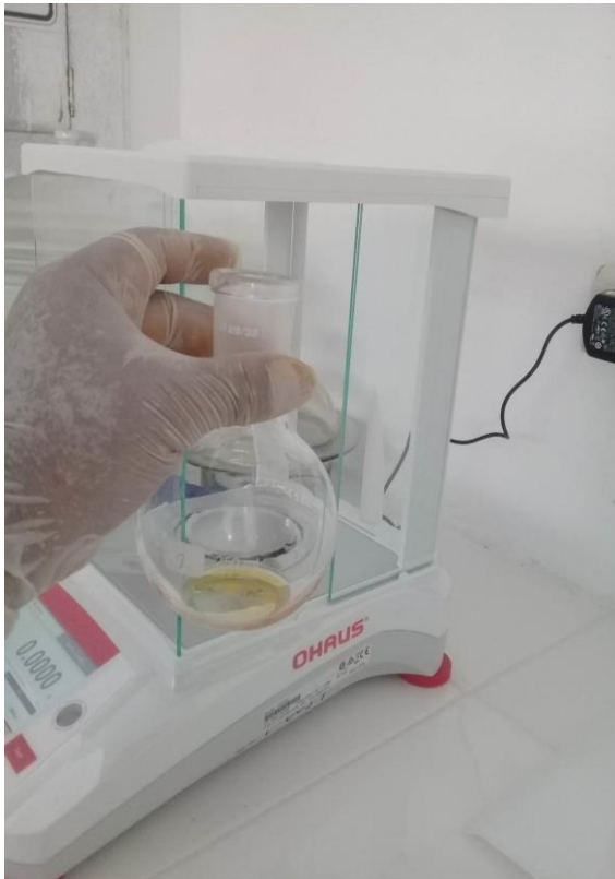
Figura 21,4. Pesado de las grasas extraídas de las muestras de papas fritas.
