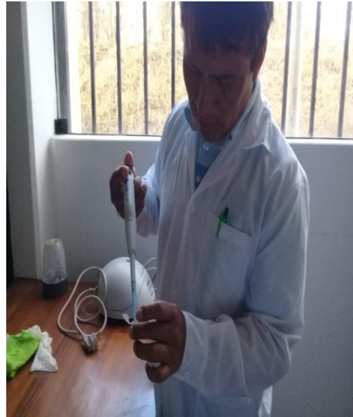
Figura 25,3. Llenado de muestras a los microtubos para la centrifugación.
