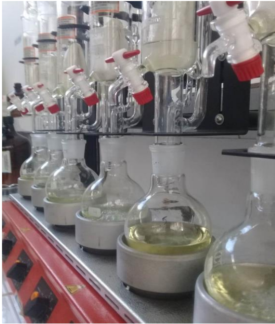
Figura 21,3. Extracción de grasa en ebullición de éter de petróleo en el equipo Soxhlet.
