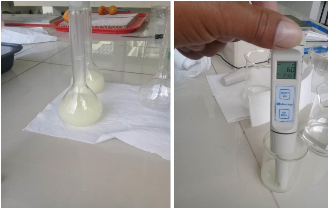
Figura 23,1. Análisis de pH de la solución de muestras de papas fritas.
