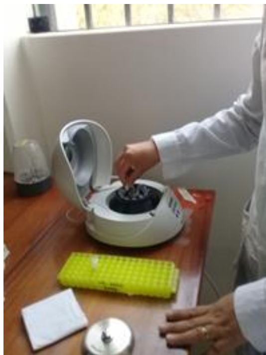
Figura 25,3. Llenado de muestras a los microtubos para la centrifugación.
