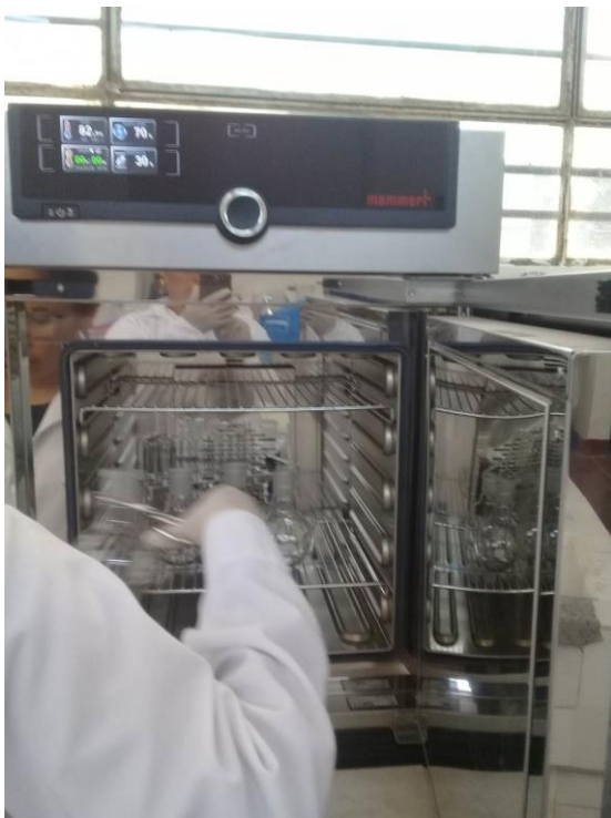
Figura 20,3. Secado en estufa de las muestra de papas fritas.
