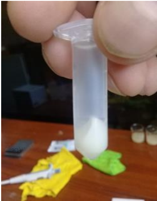
Figura 25,5. Extracción de líquido sobre nadantes de las muestras centrifugadas.
