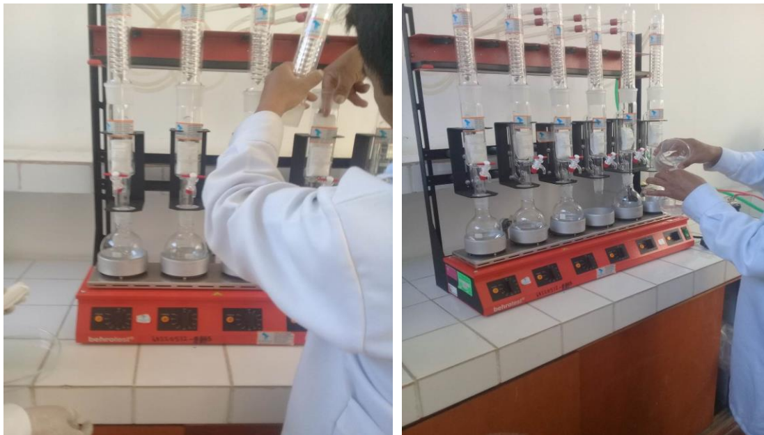
Figura 54,2. Colocación de cartuchos de las muestra de papas fritas y adición de éter de petróleo al equipo Soxhlet.
