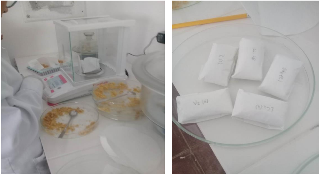
Figura 21,1. Pesado y preparación de cartuchos de las muestra de papas fritas.
