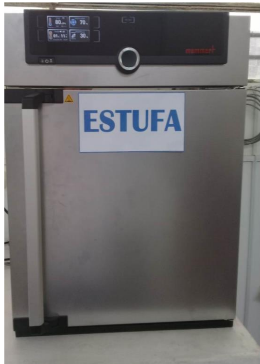
Figura 20,3. Secado en estufa de las muestra de papas fritas.
