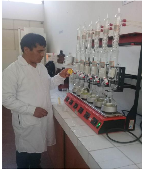
Figura 21,3. Extracción de grasa en ebullición de éter de petróleo en el equipo Soxhlet.
