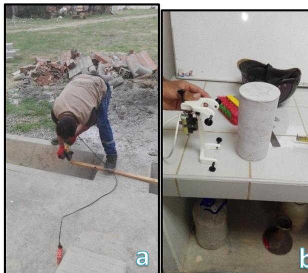
Figura 2-21 Preparado de los sujetadores (a) cortado de cubos de madera, (b) medida del LVDT para pegar los cubos de madera a la muestra.
