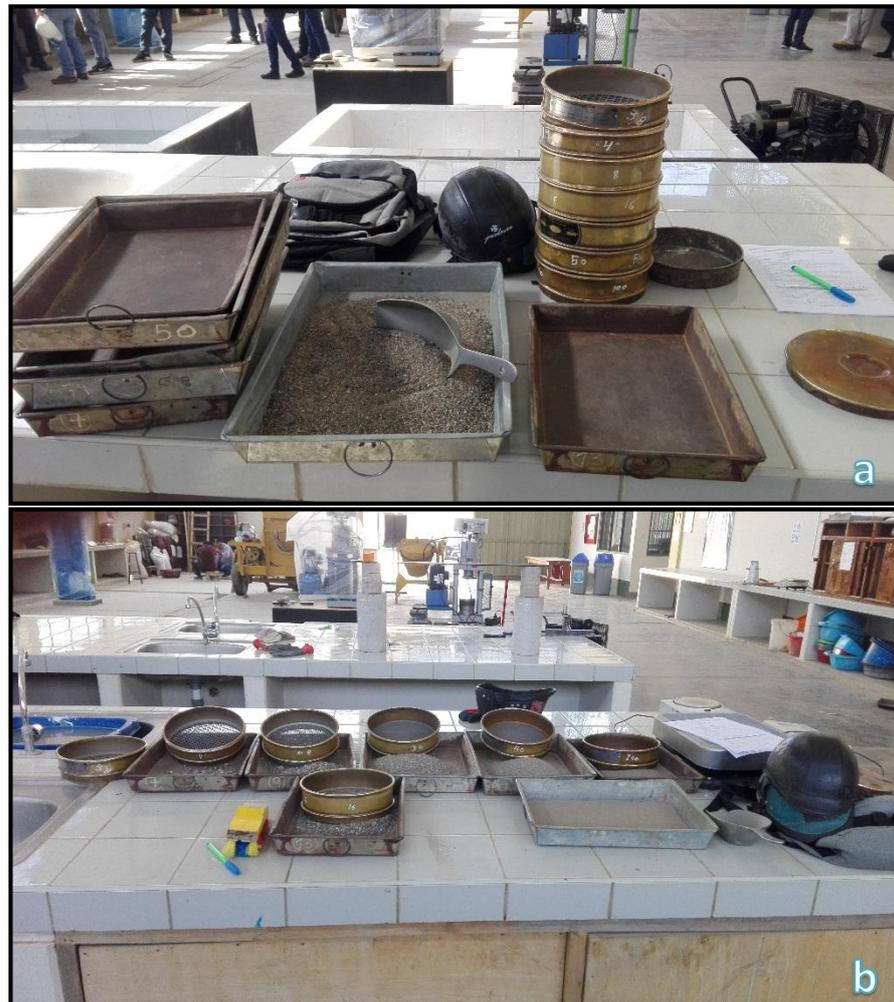
Figura 2-7 Tamizado del agregado fino (a) inicio de tamizado por cada una de los tamices, (b) muestra retenida en cada tamiz.
