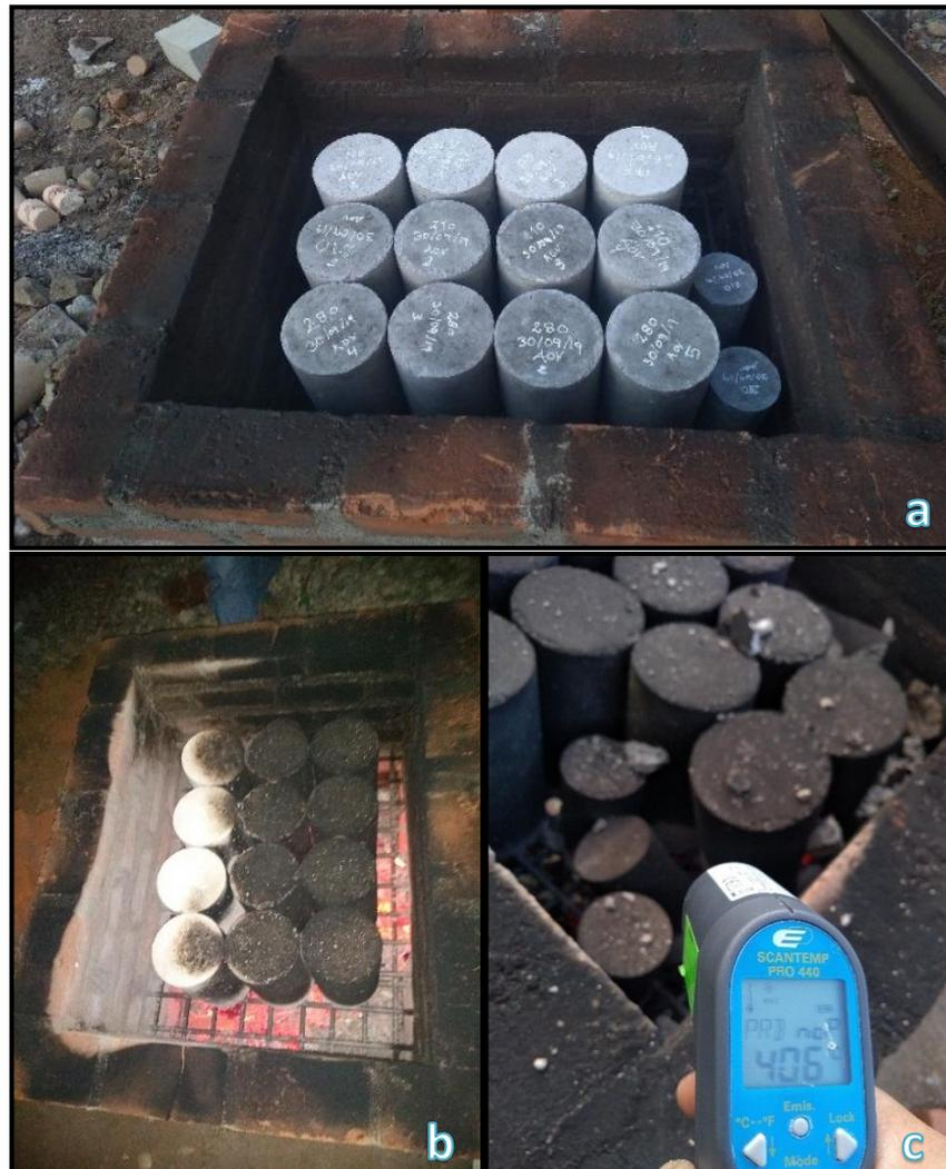
Figura 2-12 Quemado de muestras (a) Muestras ubicadas en el horno para ser calentadas, (b) Proceso de quemado de muestras, (c) finalizado del quemado de muestras.
