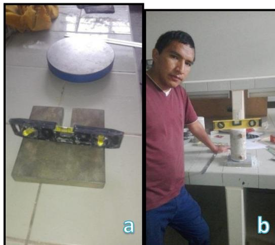
Figura 2-23 Nivelado de las muestras (a) nivelado de la superficie de apoyo, (b) nivelado de la muestra refrendada.
