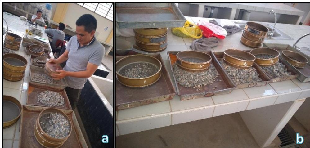
Figura 2-5 Tamizado del agregado grueso (a) pasando por cada una de los tamices, (b) retenido de cada tamiz.
