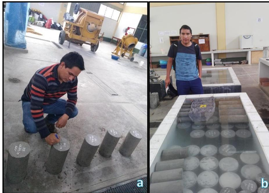
Figura 2-11 Muestras endurecidas (a) Etiquetado de las muestras, (b) sumergido de muestras para el curado.
