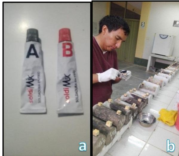
Figura 2-22 Proceso de colocado de los sujetadores del LVDT (a) Pegamento SOLDIMIX utilizado, (b) pegado de los cubos de madera a la posición correcta.
