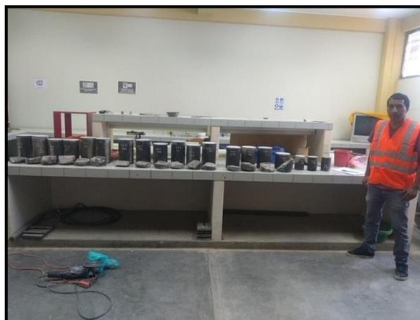
**Figura 2-17 muestras de diferente altura listas para ensayar.**
