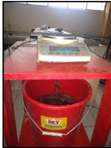
Figura 2-4 Sistema para determinar el peso sumergido
