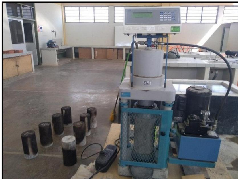
Figura 2-16 Ensayo para determinar la resistencia a la compresión de las muestras.
