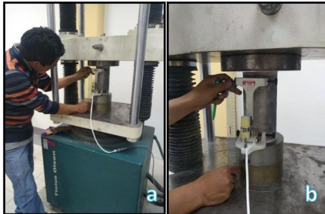
Figura 2-24 (a) Colocado de la muestra a la maquina universal, (b) Medida de la altura del LVDT para ser ensayada.
