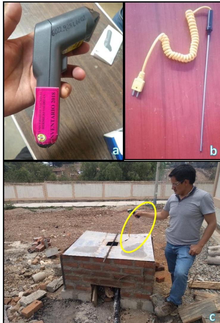
Figura 2-15 Medición de la temperatura (a) termómetro SCAM TEMP440, (b) termocupla o termopar tipo “K”, (c) medición de la temperatura del horno con la termocupla conectada.
