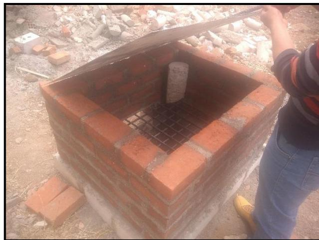
Figura 2-13 Horno terminado para calentar las muestras.
