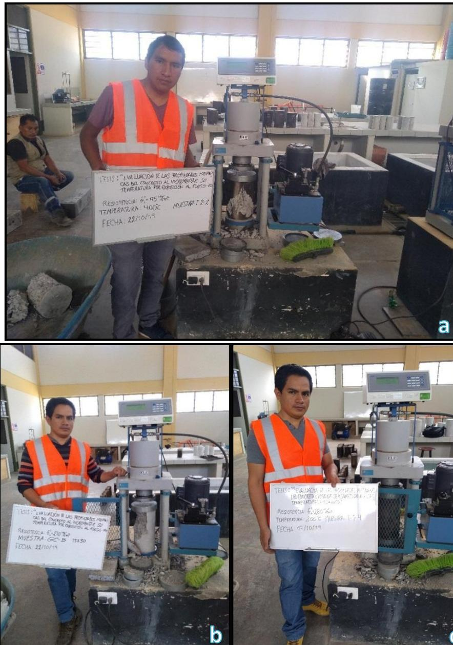
Figura 2-18 Ensayo de compresión (a) ensayo para la muestra de  $a/c=0.45$ , (b) ensayo para la muestra de  $a/c=0.55$ , (c) ensayo para la muestra de  $a/c=0.62$ .
