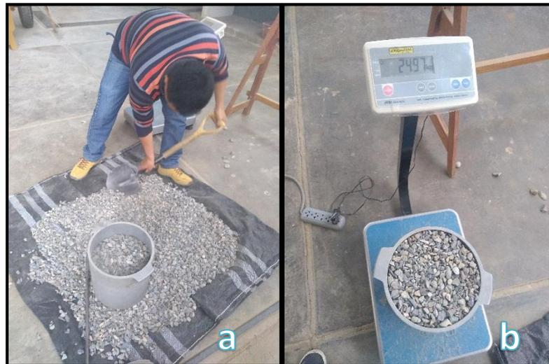
Figura 2-3 Agregado grueso (a) selección de muestra por cuarteo, (b) pesado de la muestra.
