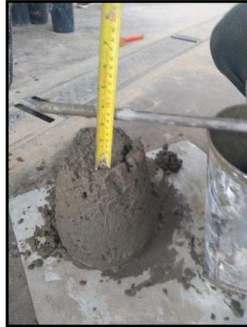
**Figura 2-9 Medición del asentamiento usando el cono de ABRAMS.**
