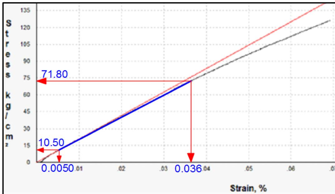
Gráfico 2-15 Curva de módulo elástico para el grupo T1 concreto de relación a/c=0.62 de la muestra T1-1.
