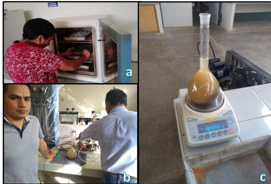
Figura 2-6 (a) secado en el horno, (b) eliminación de vacíos usando la bomba de vacíos, (c) Peso del agregado fino introducido en la fiola.
