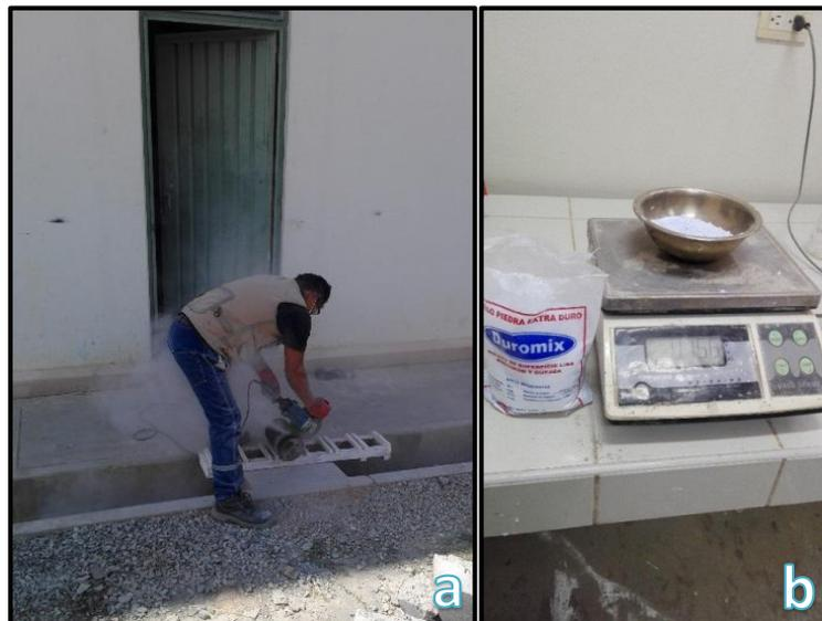
Figura 2-19 Refrendado de las muestras (a) nivelado de la muestra lijando las caras, (b) pesado de la pasta DUROMIX.
