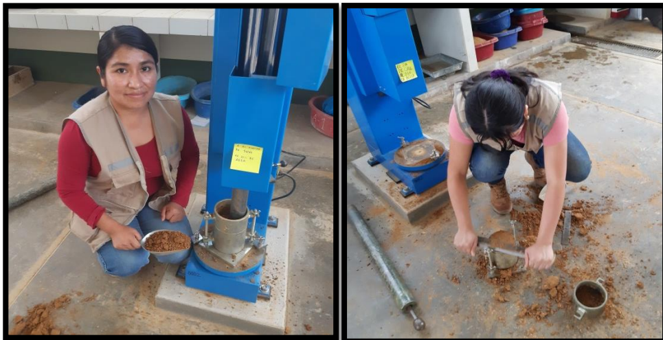
Fotografías N°30 y N°31: En las fotografías se muestra el ensayo de proctor con la maquina compactadora
