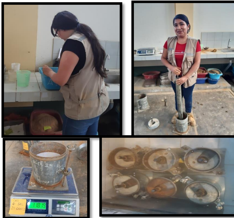
Fotografías N°35, N°36, N°37 y N°38: Se observa procedimiento de compactación para el ensayo de CBR y las muestras sumergidas.
