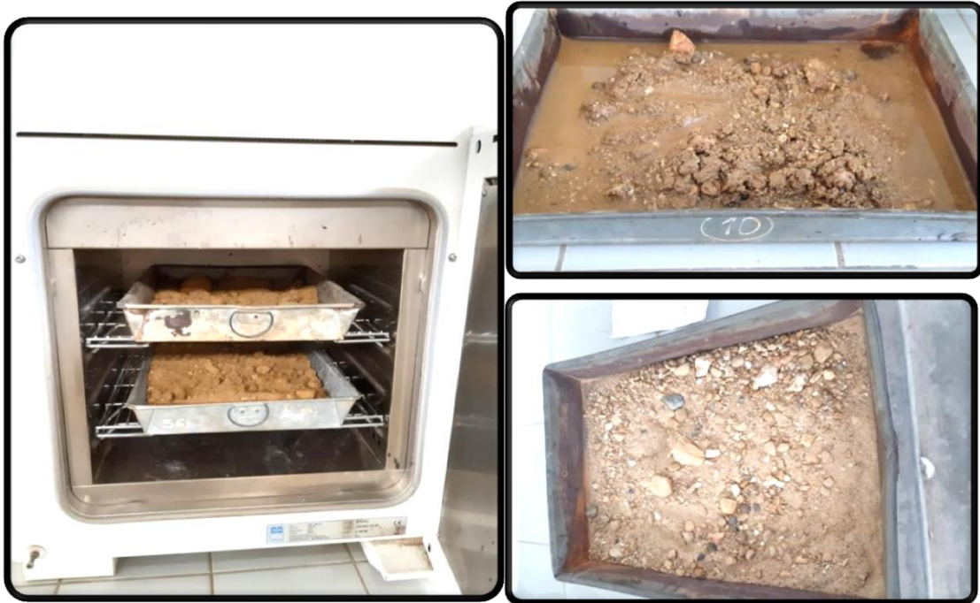
Fotografías N°04, N°05 y N°06: En el lado izquierdo secando el material en el horno a temperatura 110°C y en el lado derecho la muestra de suelo antes y después de secar.
