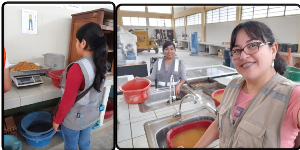
Fotografías N°02 y N° 03: Pesado y lavado de la muestra para realizar el ensayo de granulometría
