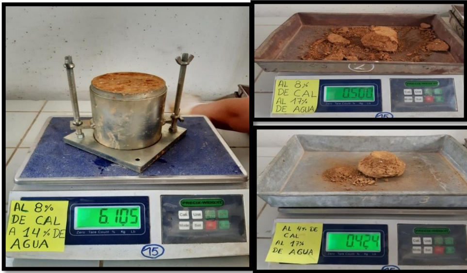
Fotografías N°32, N° 33 y N°34: En las fotografías se muestra el pesado de el molde mas la muestra humeda y la porcion de suelo para llevarlo al horno por 24 horas.
