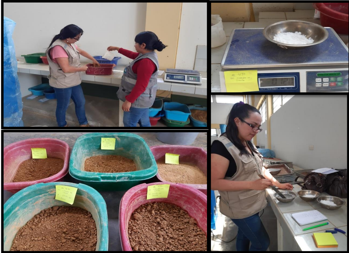
Fotografías N°26, N°27, N°28 y N°29: Se observa el momento en el cual se agregó el agua y aditivos para el ensayo de proctor.
