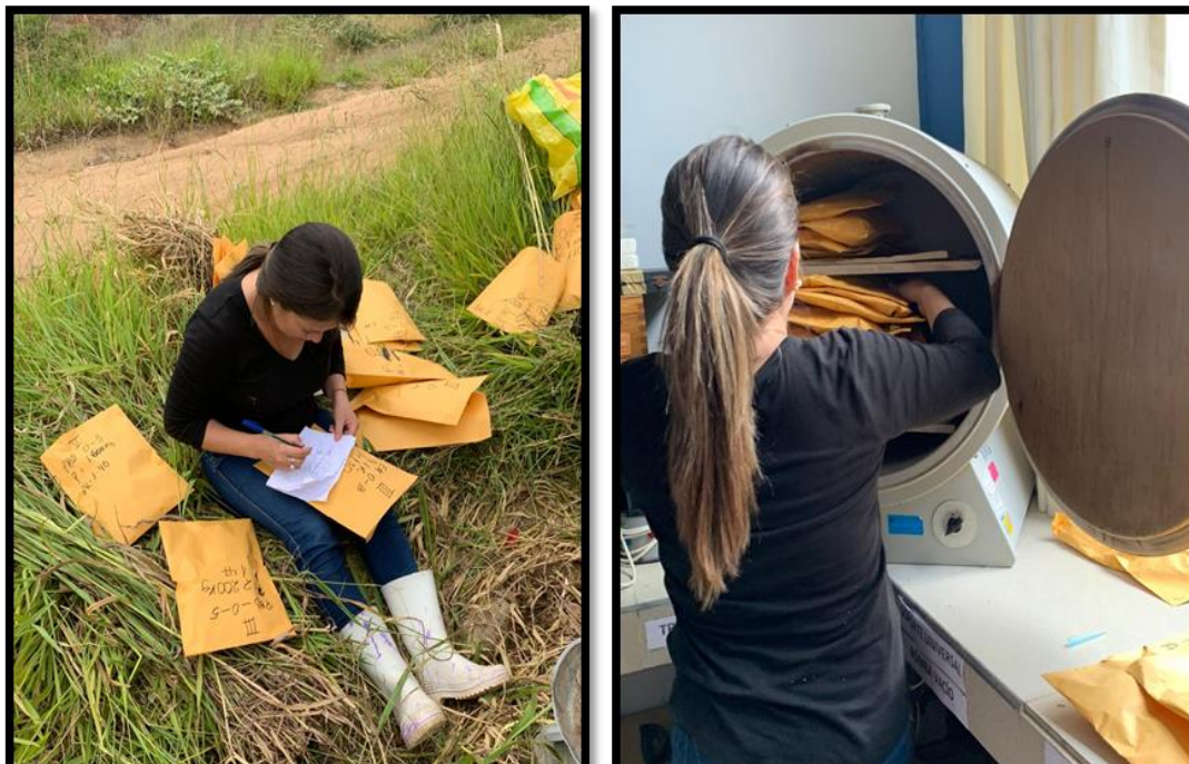
Fotografía N° 20 Y 21: Colocar en la estufa la muestra recolectada a 60°x48 horas.
