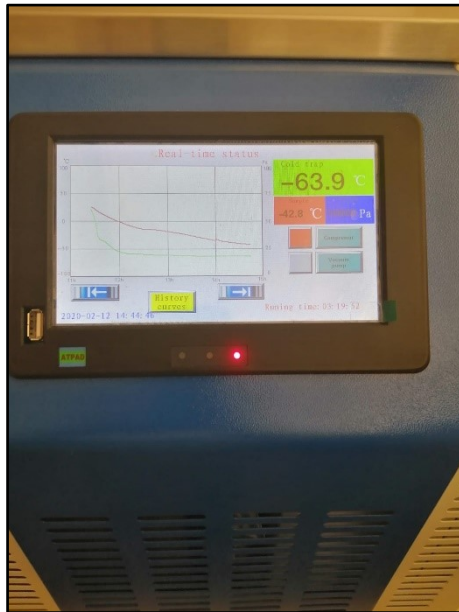
Fotografía N°7. Proceso de Liofilización finalizado por 24 horas.
