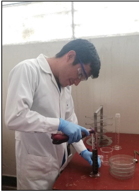
Fotografía N°1. Medición de unidad ml. En probeta milimetrada para la colocación en la platina de refrigeración Liofilizador.
