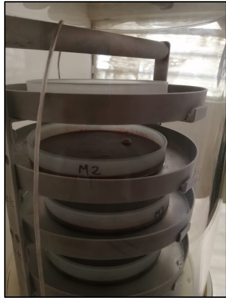
Fotografía N°2. Colocación de Croton Lechleri (sangre de Grado) a las platinas para la refrigeración de 24 horas.
