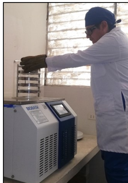
Fotografía N°3 y N°4. Refrigeración de la muestra por 24 horas.
