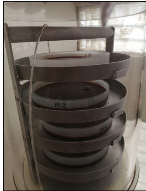
Fotografía N°7. Proceso de Liofilización finalizado por 24 horas.
