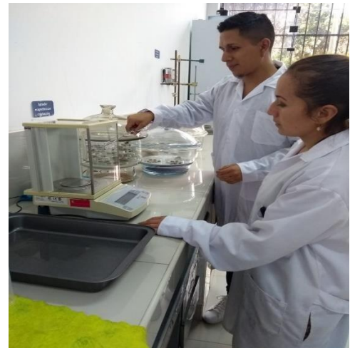
Figura 36. Pesado final de la humedad
