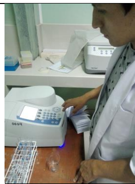
Lectura en el espectrofotómetro a 725 nm
