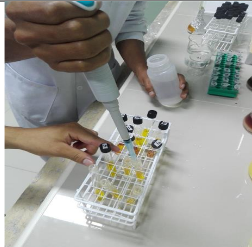
Adición de 1 mL de agua destilada a la muestra
