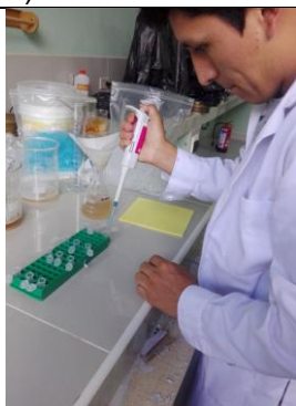
Se pipeteó 200 \mu L de muestra + 400 \mu L solución A + 400 \mu L Solución B
