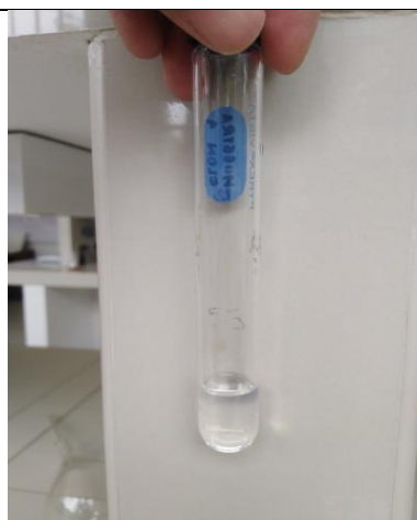
25 mg almidón + 0,25 mL alcohol 95° + 2.25 mL de hidróxido de sodio
