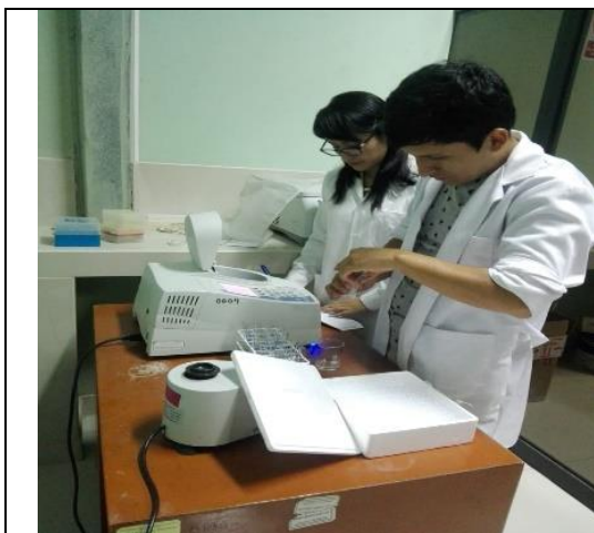
Se homogenizó y se adicionó la muestra en las celdas de poliestireno de espectrofotómetro
