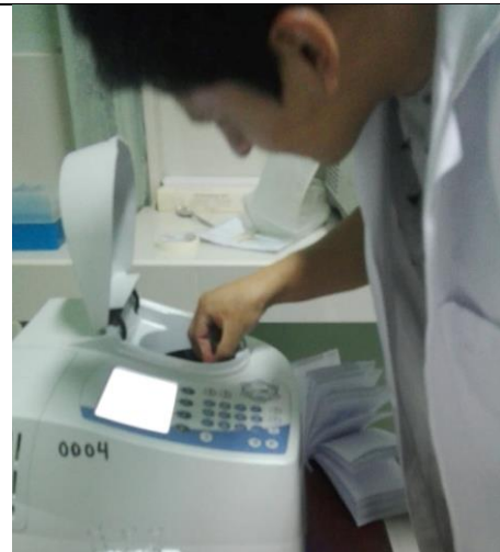
Lectura de muestra en el espectrofotómetro con absorbancia 620 nm
