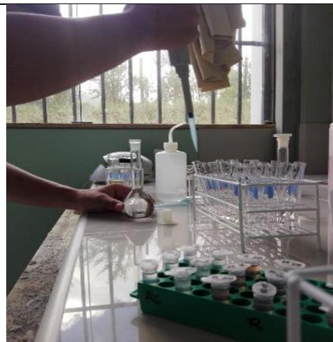
Dilución de 80 \mu L muestra + 460 \mu L buffer pH=1.0 + 460 \mu L buffer pH=4.5
