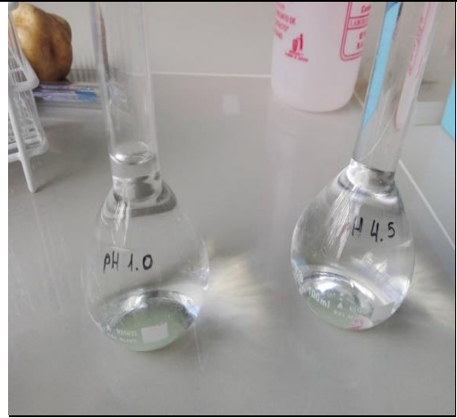
Solución Buffer pH = 1,0 y Buffer pH = 4,5
