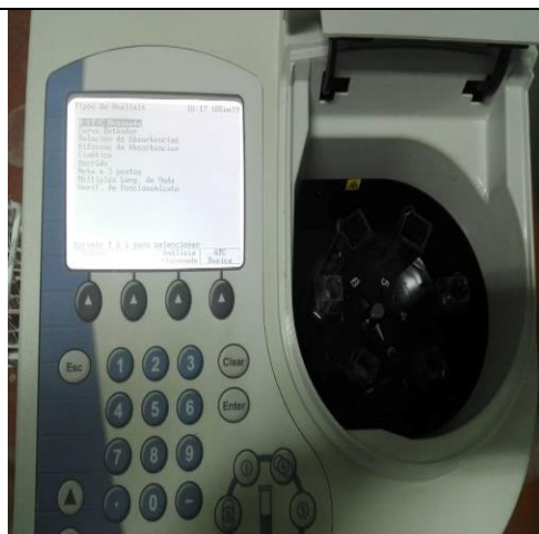
Lectura de muestra en el espectrofotómetro con absorbancia 540 nm
