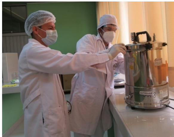
Figura (22) purificación y esterilización del medio de cultivo por 20 min a 121°C por
