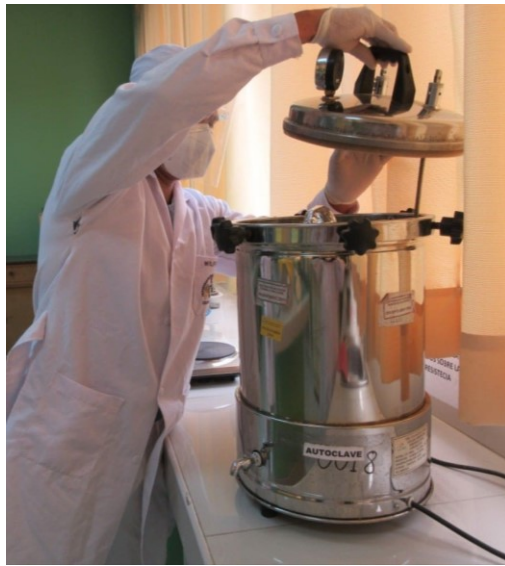
Figura.41 Cerramos hermeticamente el autoclave y purificamos el medio de cultivo a 121°C x 15 lb de presión .
