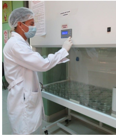
Figura 42 . se esterilizan las placas petri con rayos UV en la cámara de flujo laminar
