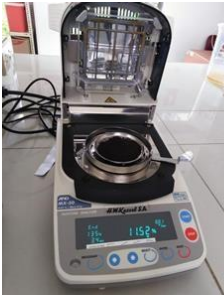
IMAGEN N°1. DETERMINACION DE HUMEDAD "TRATAMIENTO 4"
