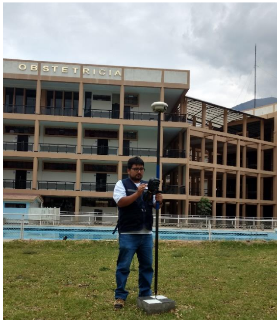
Fotografía 13: Levantamiento Geodésico al costado de la piscina de la Unheval
