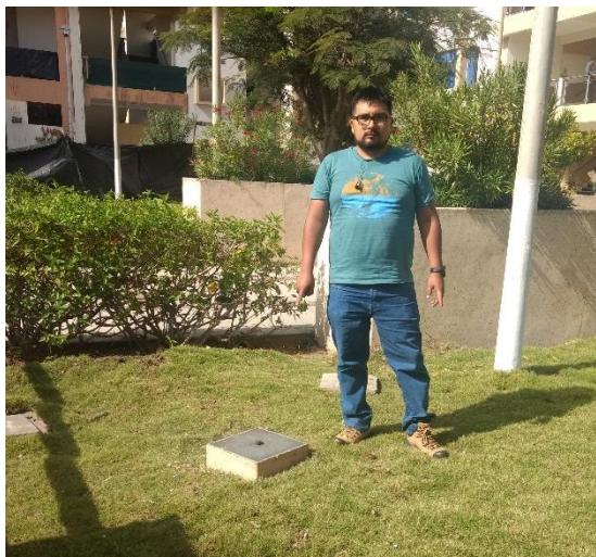
Fotografía 2: Punto de control de concreto simple en la Universidad Nacional Hermilio Valdizan
