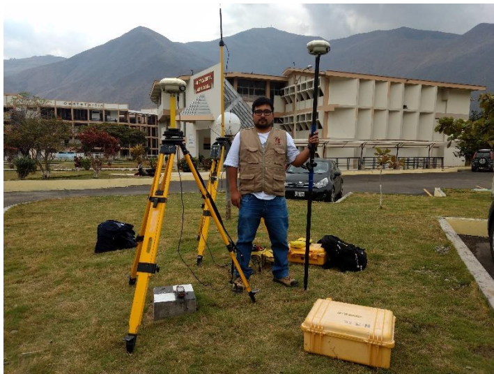
Fotografía 12: Levantamiento Geodésico de los puntos de control
