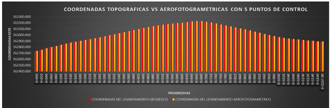
Figura 72: grafico de barras de las coordenadas ESTE del levantamientos topográfico vs aerofotogrametrico del eje de la vía con GSD 3.5 cm/pixel y con la cantidad de 05 puntos de control
