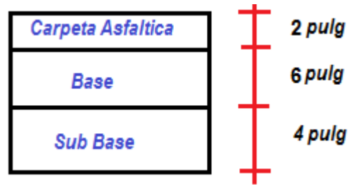
Figura N° 18: Estructura del pavimento flexible – método MTC
