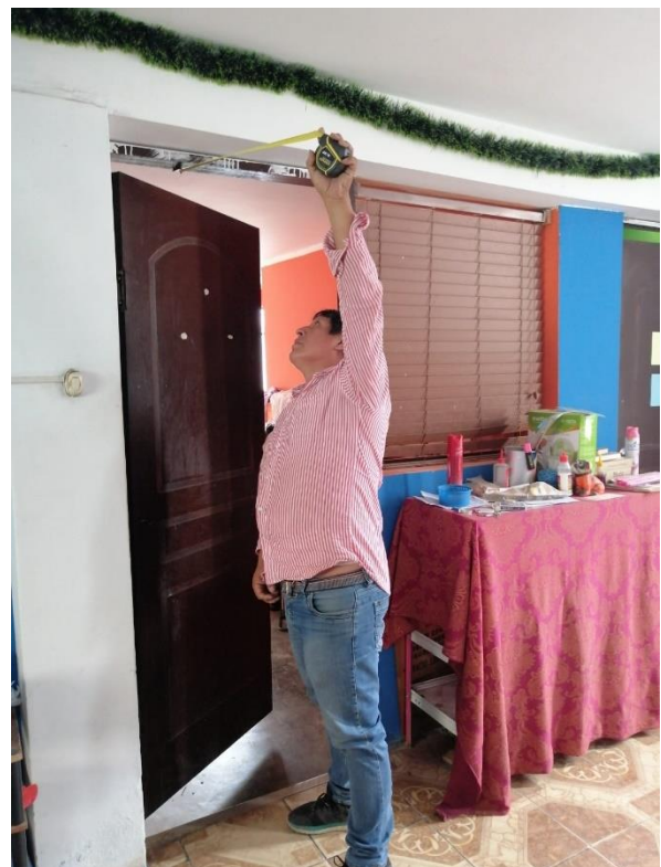
Imagen N° 8: Verificación de las dimensiones del peralte de vigas en viviendas autoconstruidas- segunda vivienda en estudio
