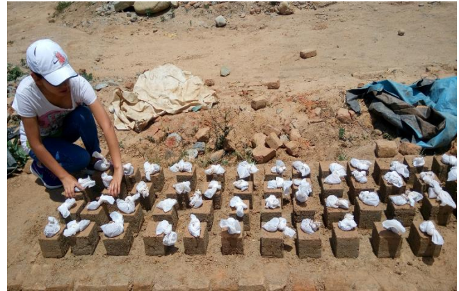
Figura 14. Se dejó secando los adobes para luego llevarlos al laboratorio.
