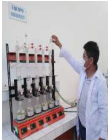
Colocado de muestra en el cuerpo del aparato soxhlet
