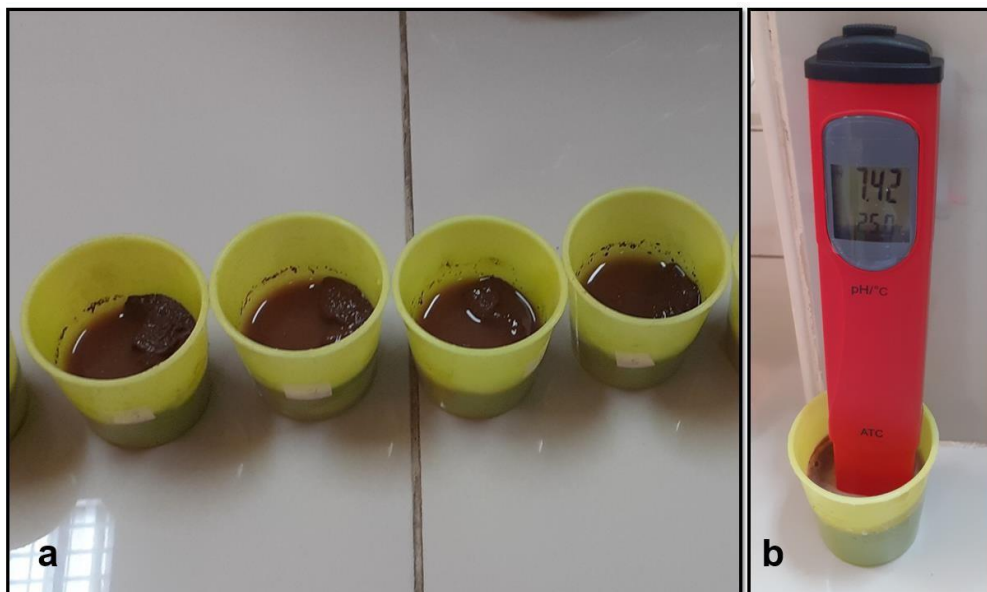
Figura 25. Determinación de pH. Maceración de las muestras (a), lectura de pH con el potenciómetro (b).
