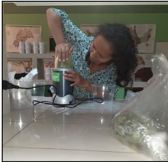
Figura 28. Triturado con el molinillo de las muestras de hoja y almendras de cacao.
