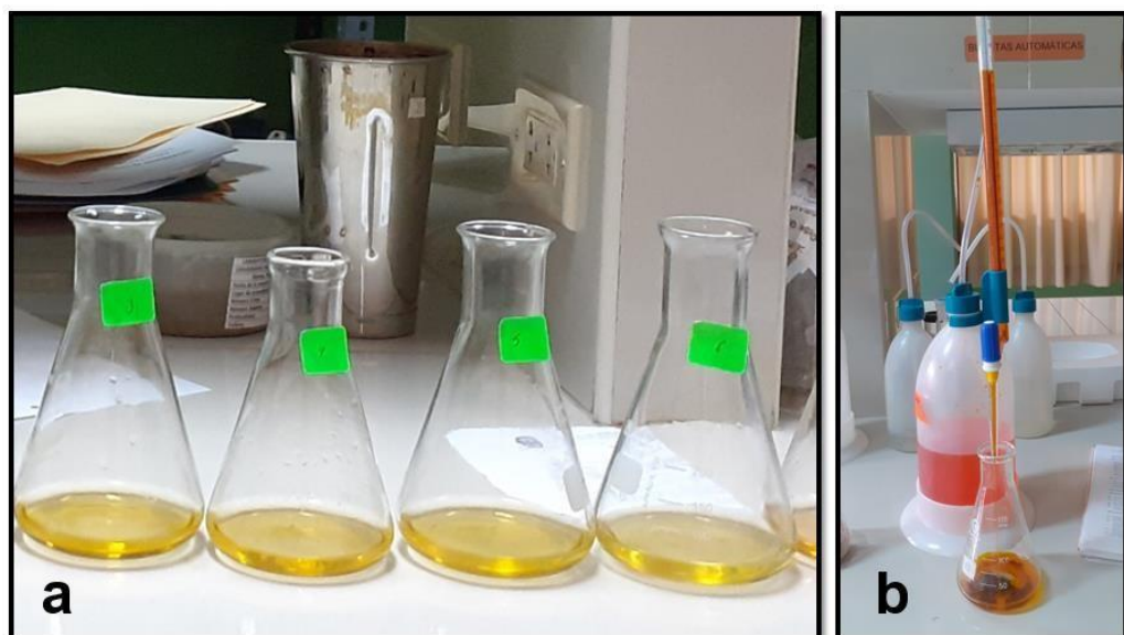
Figura 27. Determinación de carbonatos. Alícuota del filtrado (a), titulado de la muestra (b).
