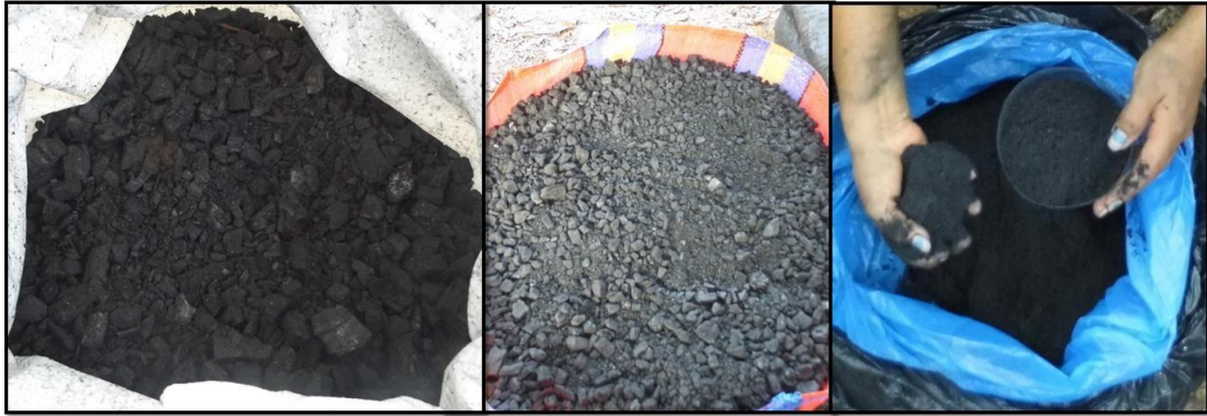
Figura 13. Etapas de triturado del biochar.
