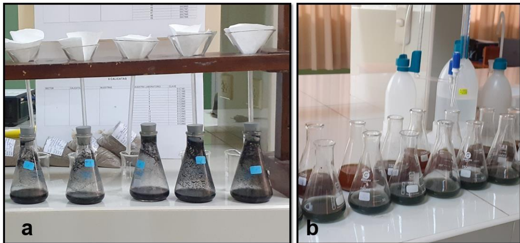
Figura 28. Determinación de materia orgánica. Muestras dispersadas (a), muestras tituladas (b).
