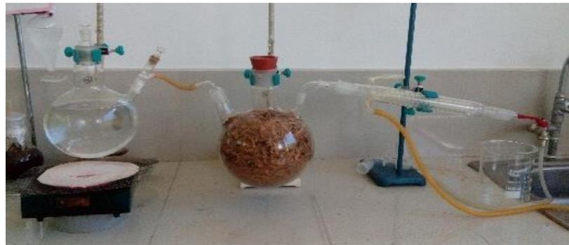
EXTRACCIÓN POR ARRASTRE CON VAPOR DE LA CANELA
