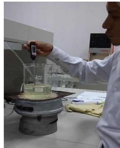
Homogenización de los insumos y control de temperatura
