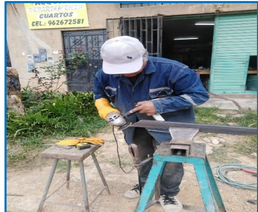
Figura 40 Esmerilando las secciones cortadas (1)
