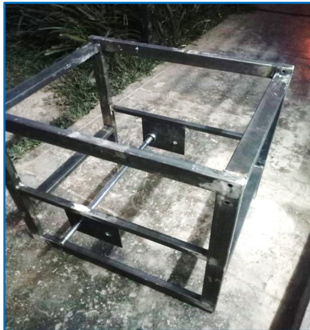
Figura 25 Estructura con soldadura eléctrica al arco, electrodos cellocord ap 6011
