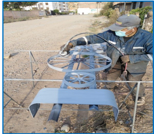
Figura 56 Pintado con pintura base (1)
