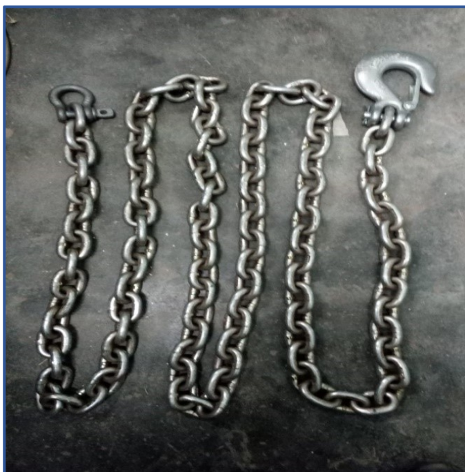
Figura 20 Cadena de acero de alta resistencia de 3/8" Fuente: Elaboración propia
