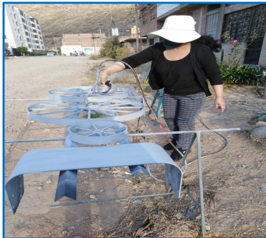
Figura 57 Pintado con pintura base (2)
