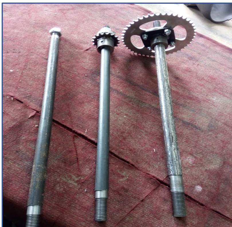
Figura 14 Ejes de transmisión de fuerza Fuente: Elaboración propia
