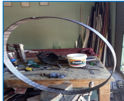
Figura 48 Enrolando el material para las ruedas.
