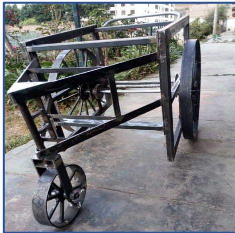
Figura 26 Estructura de la maquina unido al eje de las ruedas (0.75 x 0.60 x 0.70) Fuente: Elaboración propia
