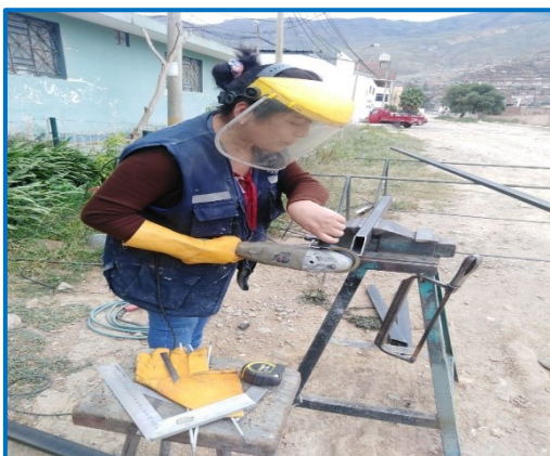
Figura 42 Esmerilando las secciones cortadas (2)
