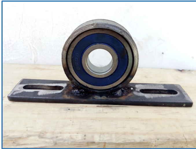
Figura 17 Vista de una chumacera para rodaje de 2" Fuente: Elaboración propia
