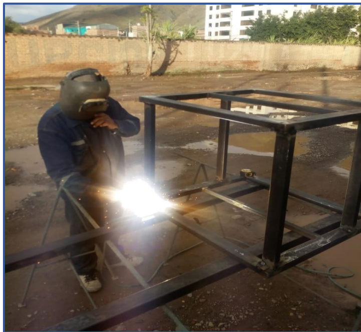
Figura 13 Estructura de la máquina cosechadora de papas Fuente: Elaboración propia.
