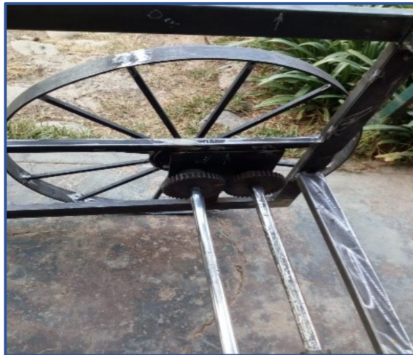
Figura 27 Instalación de las ruedas a la estructura de la maquina Fuente: elaboración propia
