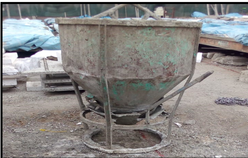
Figura N° 10 Tolva de concreto
