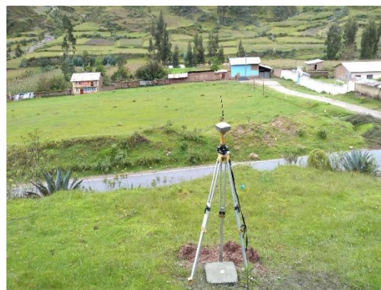
Figura 20. Hito de Concreto de Medidas 40 X 40 Cm y 50 Cm de altura, Sobresalido 15 Cm. Del nivel del suelo, con Placa de Bronce de Diam. 70 mm Ubicada en la Parte Superior de la Carretera Central Huánuco la Unión, al Frente de la Progresiva 0+000 Km.
