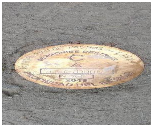
Figura 22. Placa de bronce de 07 cm de diámetro en el puntos de control georreferenciado.
