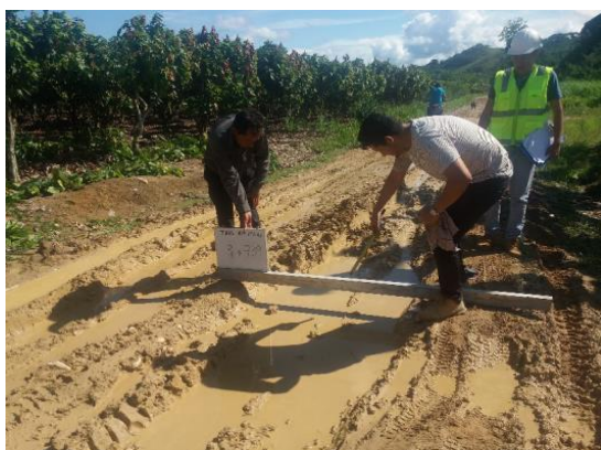
Figura 5. Registro de deformación en invierno, G=3.
