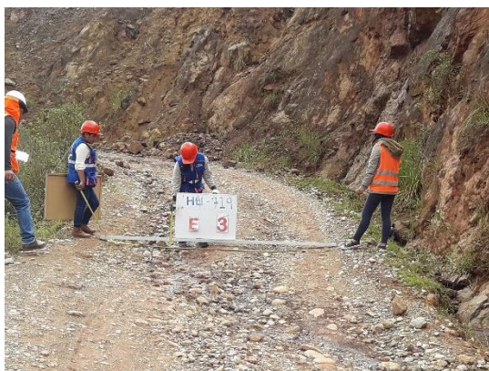
Figura 13. Medición de erosión.
