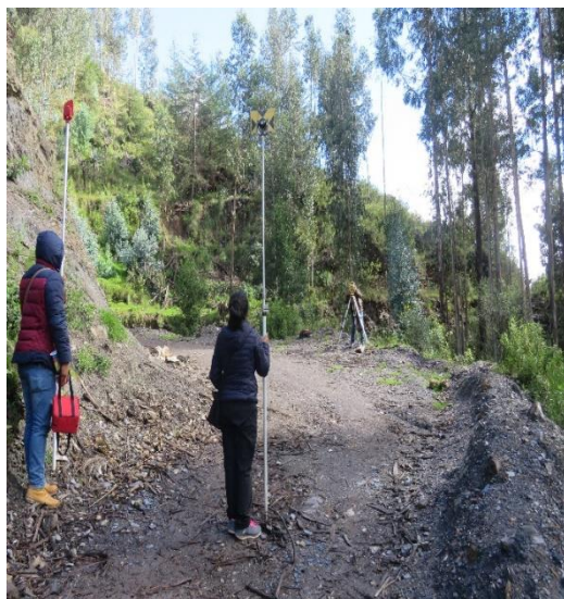
Figura 1. Medición de pendiente geométrica vertical con el método directo, tramo: Tunya.
