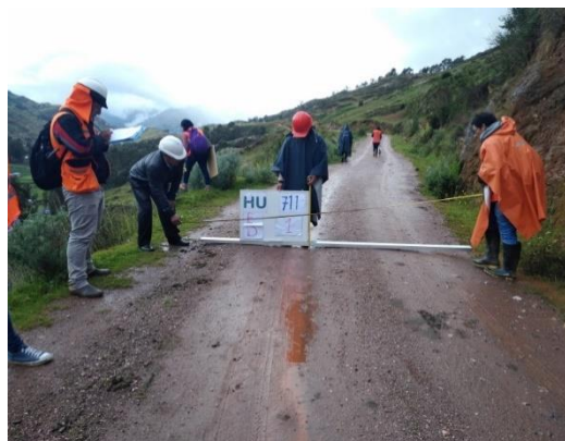
Figura 4. Foto de erosión con nivel de gravedad=1.
