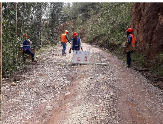
Figura 14. Medición de erosión.
