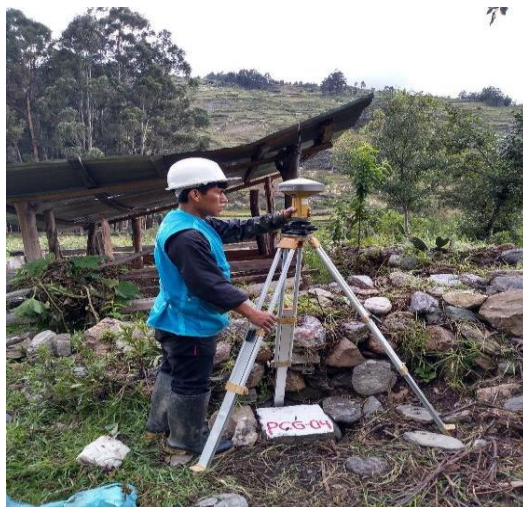
Figura 23. Punto PCG 04 se encuentra ubicado al margen derecho de la vía Tunya – Goshay (donde termina el tramo de la carretera.), sobre hito de concreto con placa de bronce de 07 cm de diámetro.
