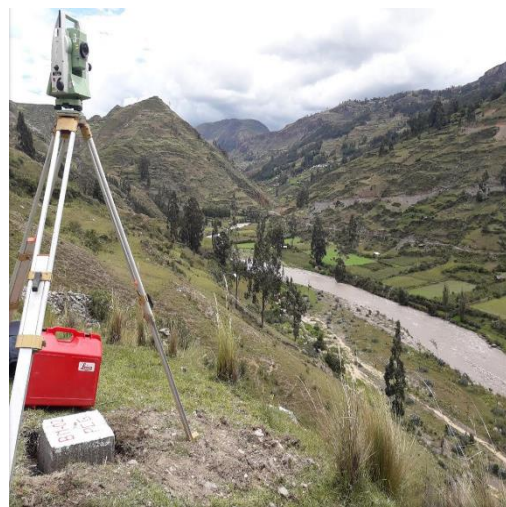
Figura 24. Punto PCG 03 se encuentra ubicado al margen izquierdo de la vía Tunya – Goshay (donde termina el tramo de la carretera.), sobre hito de concreto con placa de bronce de 07 cm de diámetro.
