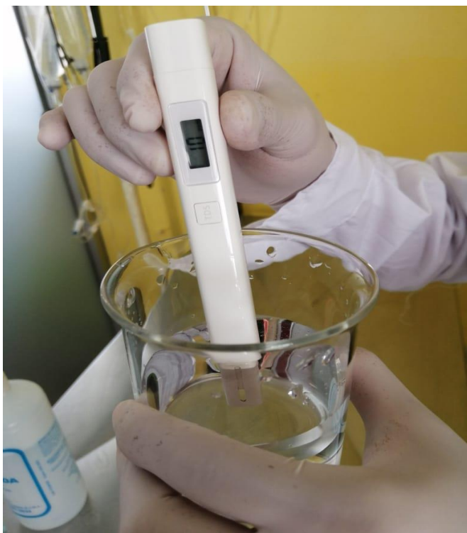
Fotografía 12. Obtención de plata coloidal de 10 ppm.
