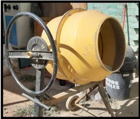
Ilustración 18 Preparación de la mezcla y elaboración de las 18 probetas
