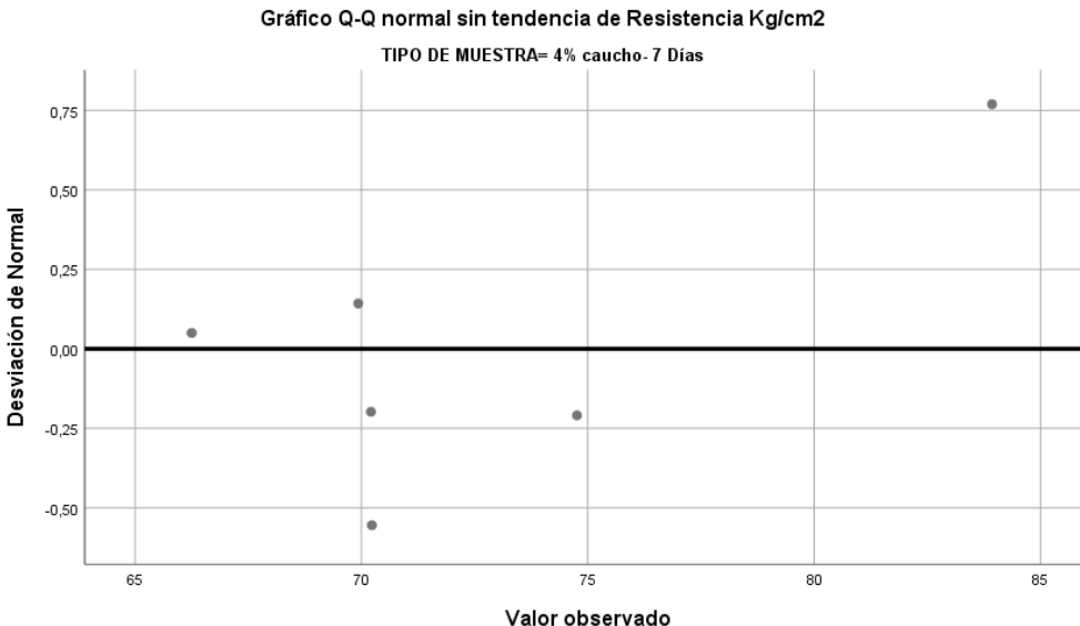
Gráfico Q-Q normal sin tendencia de Resistencia Kg/cm2 en 4%caucho-7 días.
