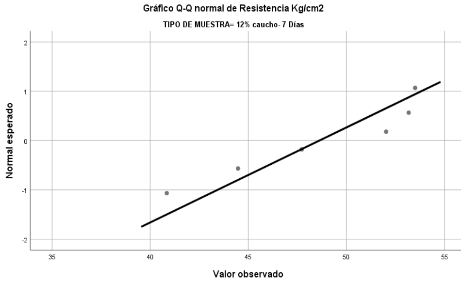
Gráfico Q-Q normal de Resistencia Kg/cm2 en 12%caucho-7 días.
