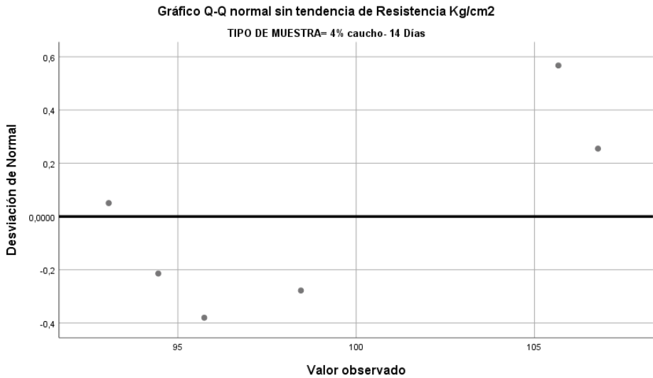
Gráfico Q-Q normal sin tendencia de Resistencia Kg/cm2 en 4%caucho-14 días.
