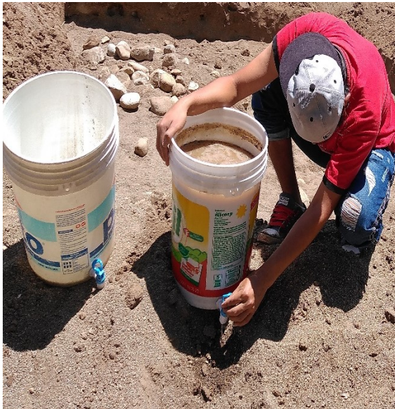
Figura 05. Prueba de percolación.
