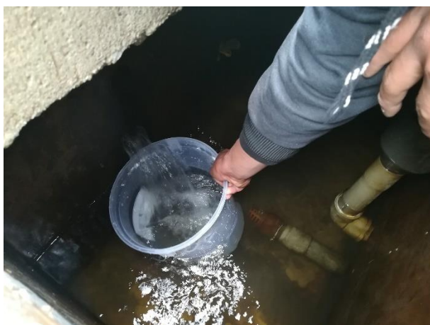
Figura 22. Determinación del caudal por método volumétrico.
