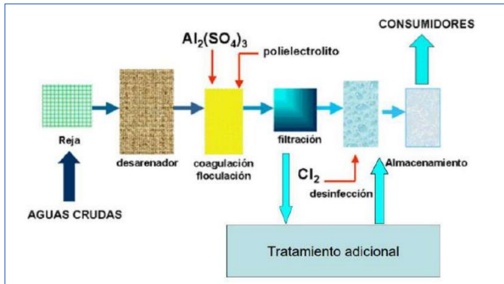
Figura 2. Tratamiento de potabilización de agua. Fuente: (Ascencio, 2005)
