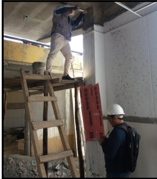
*Fotografía N° 18. Prueba de esclerómetro columna del módulo IV.*
