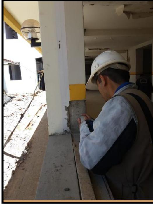
*Fotografía N° 19. Prueba de esclerómetro en la viga del módulo I.*
