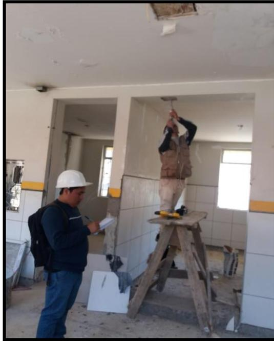
*Fotografía N° 21. Prueba de esclerómetro en la viga del módulo III.*
