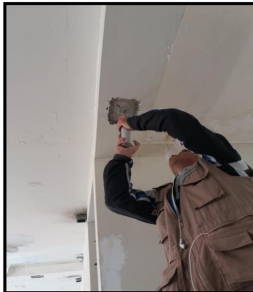
*Fotografía N° 20. Prueba de esclerómetro en la viga del módulo II.*
