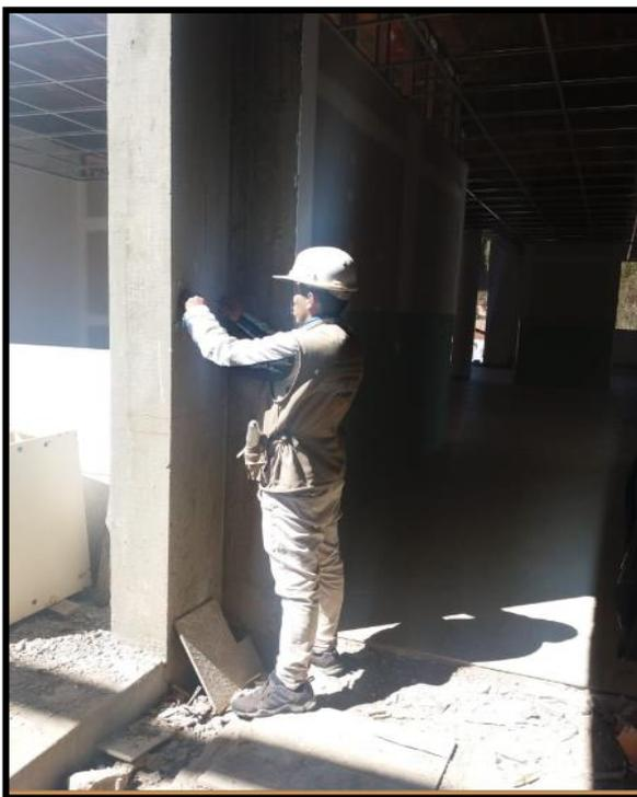
*Fotografía N° 16. Prueba de esclerómetro columna del módulo II.*
