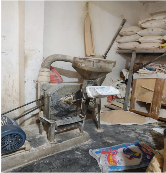
Fotografía 03. Máquina procesadora y trituradora de harina de plátano.
