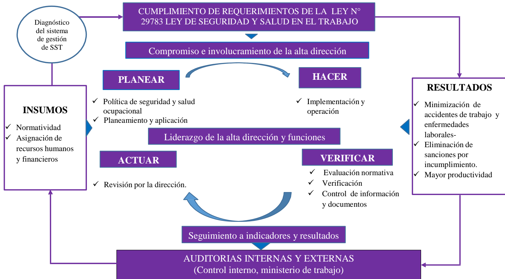
FIGURA 29. Diseño de un sistema de gestión de seguridad y salud en el trabajo
