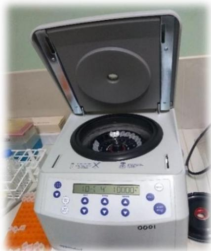
Figura 10: Microcentrífuga (4°C).
