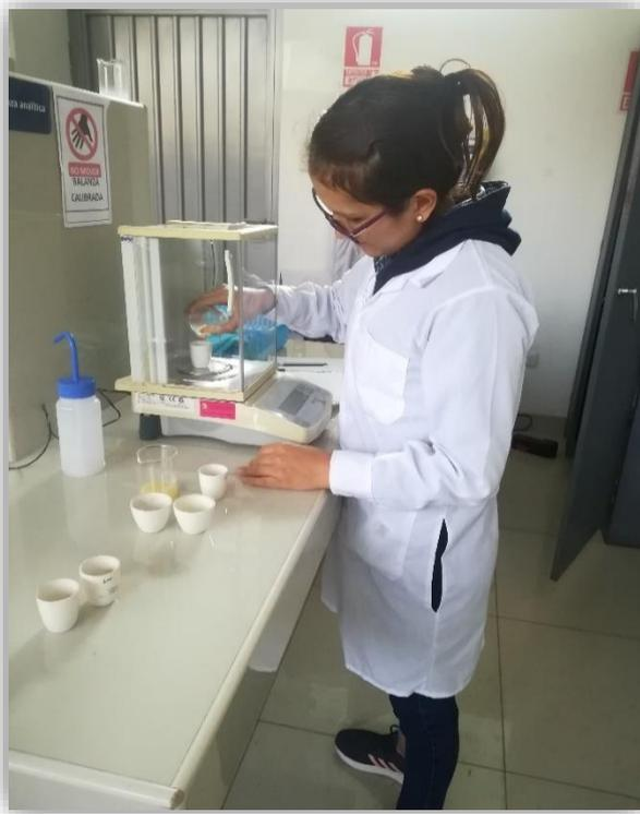
**Figura 25:** Determinación de cenizas.
