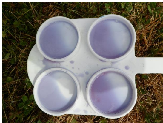
Figuras N° 8 adición de reactivo de CTM y lectura de la reactivo
