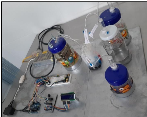
Generador de gas hidrogeno
