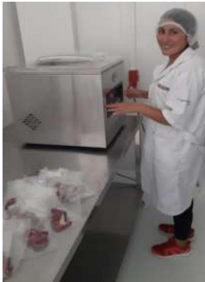
**Figura 7.** Inyección de los gases hacia las muestras.
