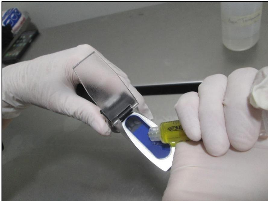
**Fotografía 13.** Colocación de gota de orina en el refractómetro para su lectura.
