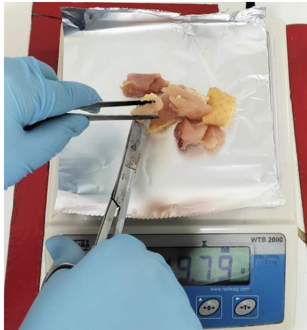
Fotografía N° 26 pesado de la muestras en una balanza electrónica. Se debe pesar 25 gr de cada muestra cárnica procesada.
