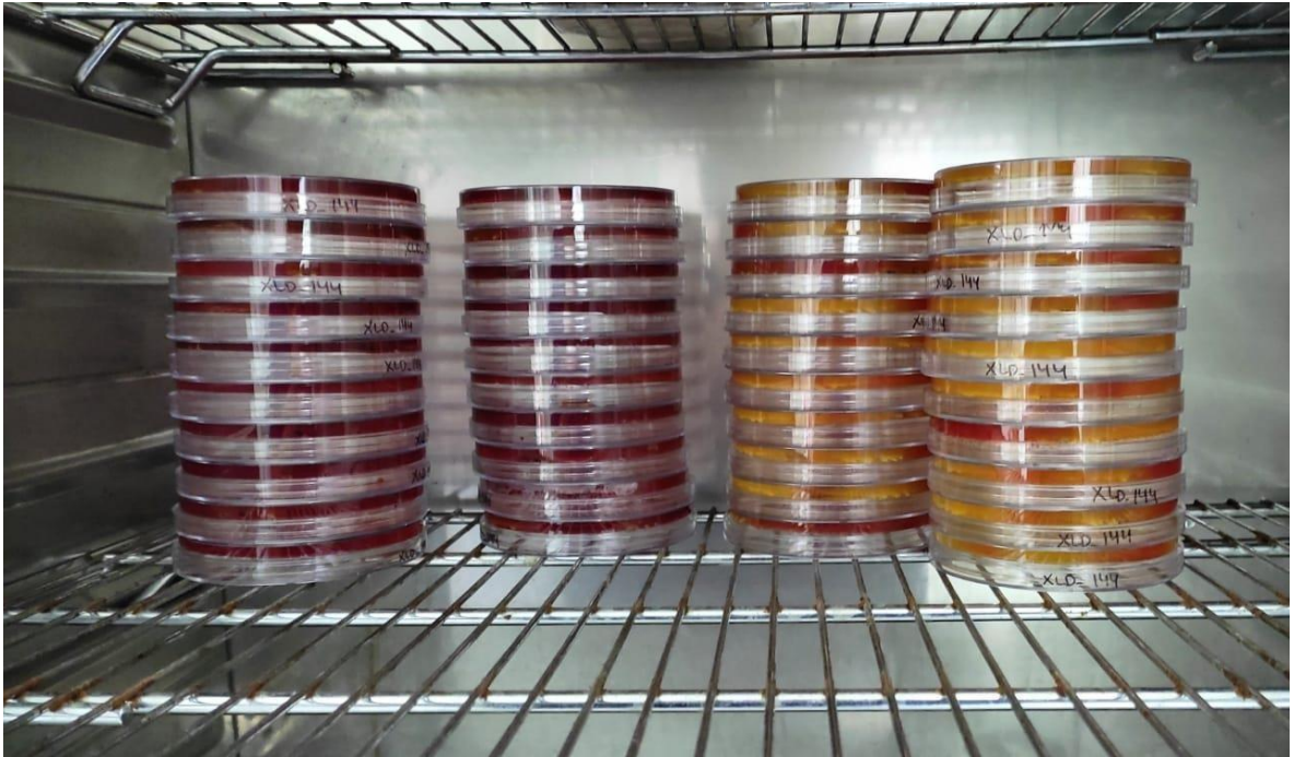
Fotografía N° 36 Agares cultivados llevados a una estufa para incubación a una temperatura y tiempo ya determinado por el instructivo para detección de salmonella spp. según ISO 6579:2017
