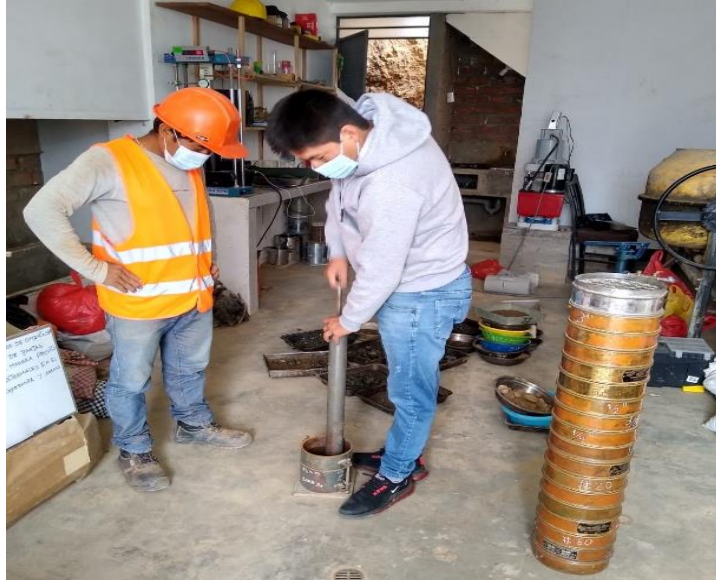
Realizando los 56 golpes a la capa de muestra de suelo en el ensayo de Proctor modificado
