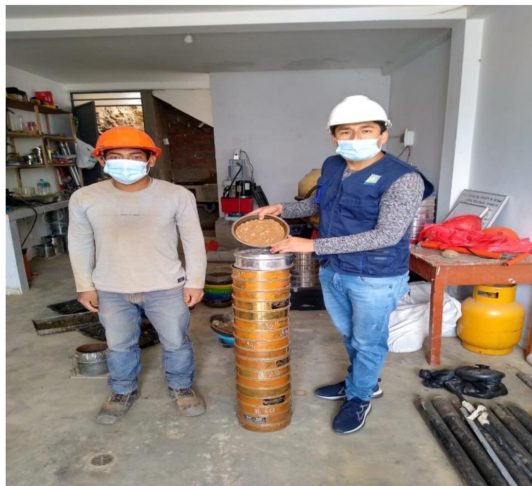
Realización de del ensayo del tamizado de la muestra de suelo
