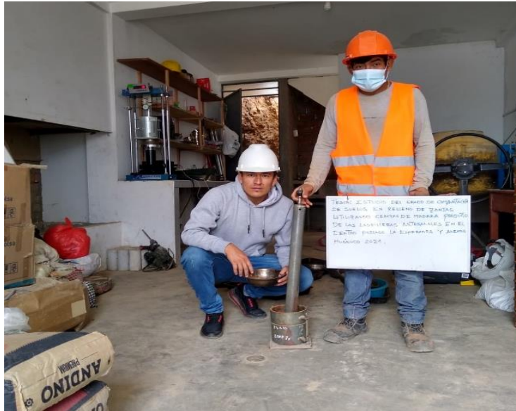
Iniciando el ensayo de Proctor modificado con la muestra de suelo con la adición de ceniza.
