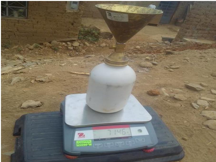
Efectuando el pesado del cono de arena un procedimiento importante para el método usado.
