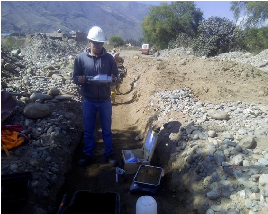
Realizando el ensayo de contenido de humedad de suelo in situ con el humedometro.
