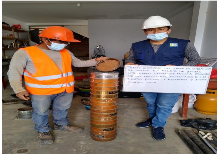
Iniciando el ensayo de granulometría de nuestra muestra de suelo.
