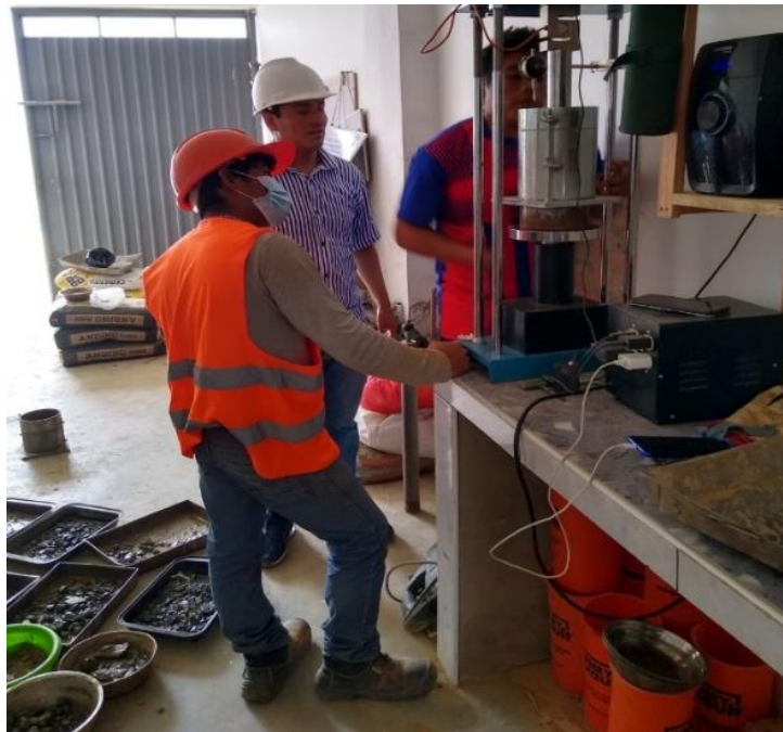
Pesado de la muestra del suelo con el molde en el ensayo de Proctor modificado.
