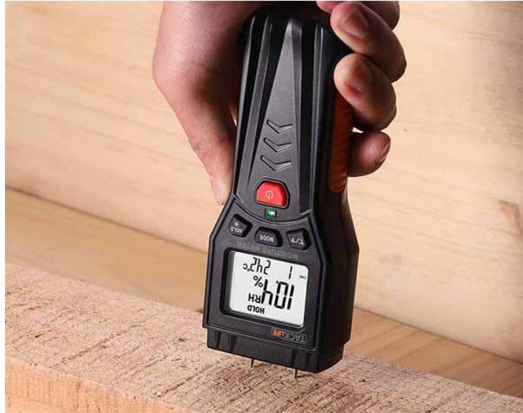
Figura 7 Instrumento para medir el porcentaje de humedad
