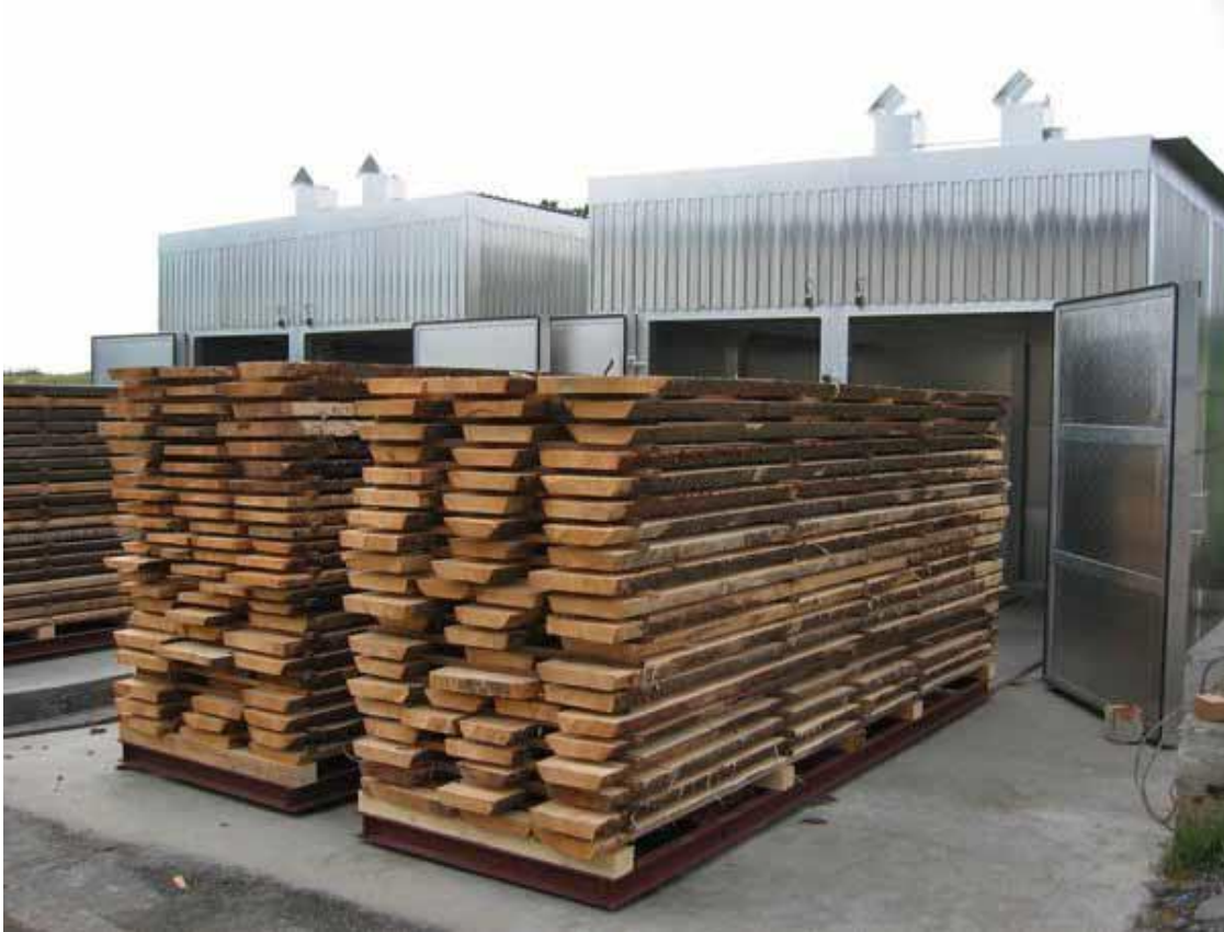
Figura 6 Secado artificial de la madera
