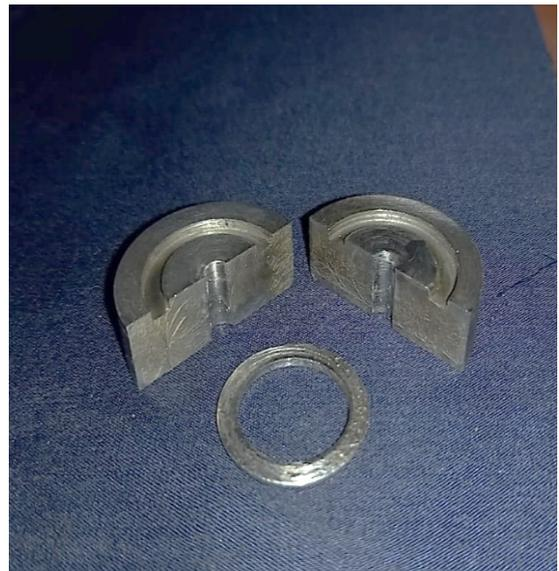
Figura 2 y figura 3. Dispositivo de acero utilizado para realizar la prueba Scraping test, profundidad de polimerización, 10 mm de profundidad y 4 mm de circunferencia.
