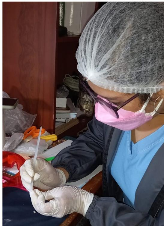
Figura 17. Se realizó el raspado de cada cilindro de resina por la parte inferior de la muestra (resina no polimerizada) con una espátula de plástico sin bordes cortantes. Figura 18. El raspado se realizó por una sola persona para evitar la discrepancia entre la fuerza de los operadores.
