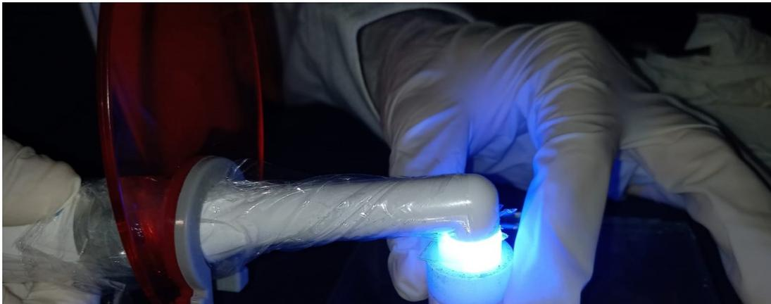
Figura 13. Polimerización de los cilindros de resina con el film (15 muestras)
