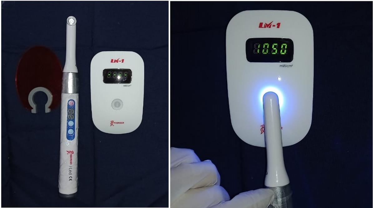
Figura 4 y figura 5. Lámpara Iled (Woodpecker) y calibrador digital con la que se midió la potencia de la luz, marca Woodpecker, se realizó la medición antes de cada prueba y después de 5 disparos.
