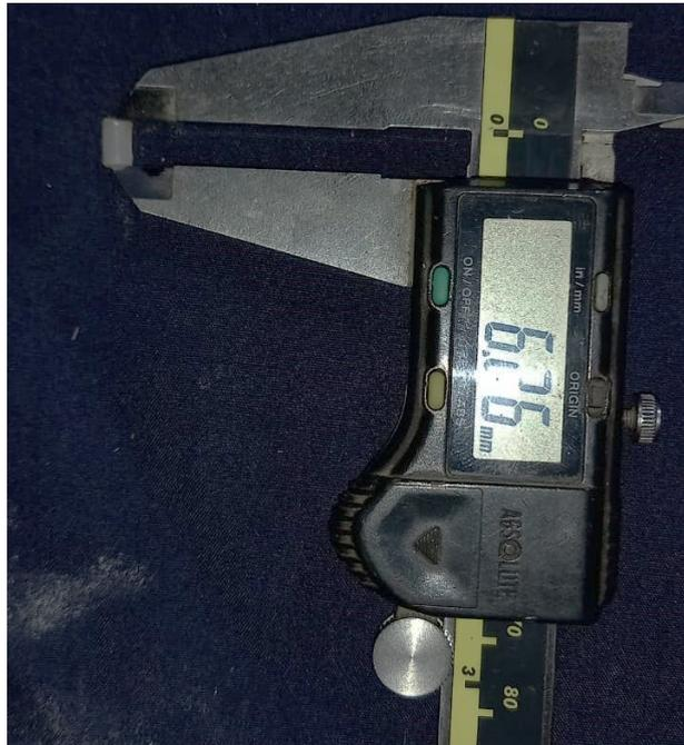
Figura 18. Una vez realizado el raspado de la muestra, se procede a la medición de la misma con un calibrador. La medición se realizó dos veces.
