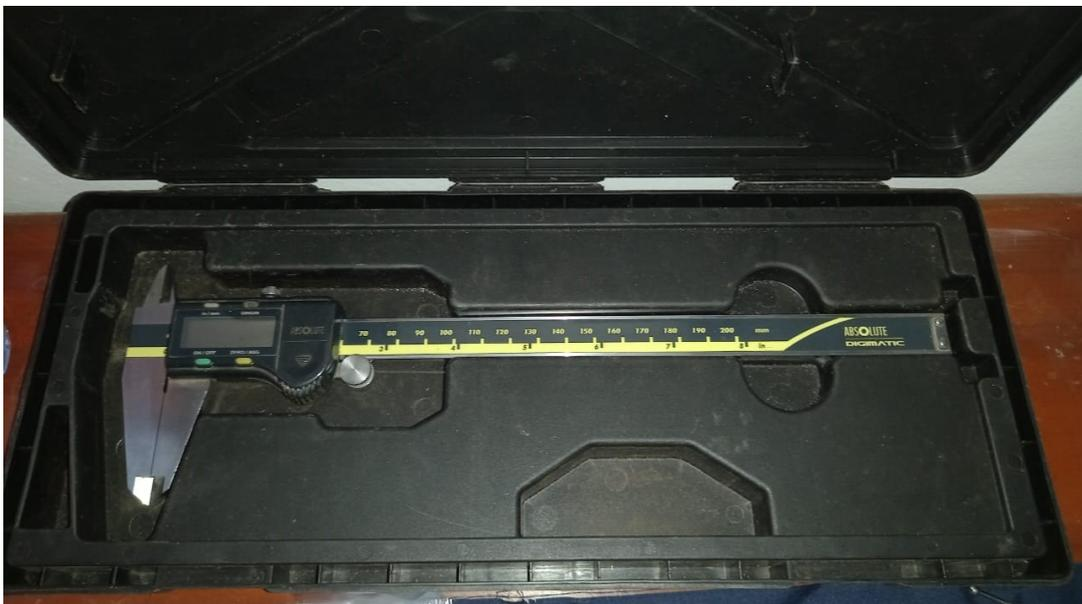
Figura 6. Calibrador digital, utilizado para la medición de las muestras (cilindros de resina compuesta de la marca opus).
