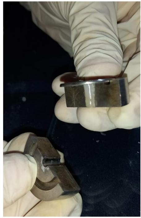
Figura 14 y figura 15. Se procedió a desmoldar los cilindros de resina, primero se retiró el adaptador del dispositivo de acero, posteriormente se desarmó para dejar libre el cilindro de resina.
