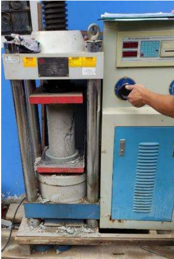
Foto 1 Ensayo de compresión de los testigos cilíndricos.
